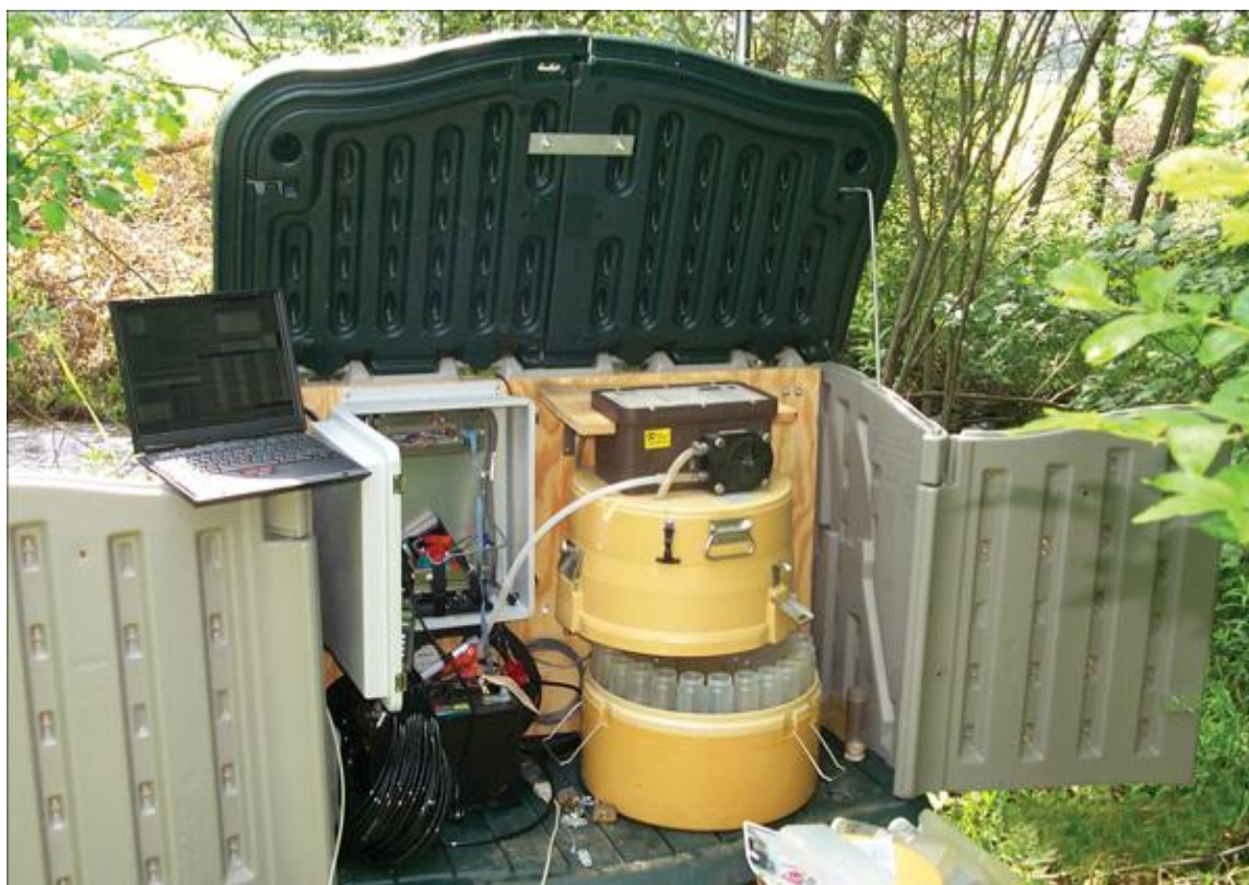
Slika 9. Automatska stanica za uzorkovanje vode
