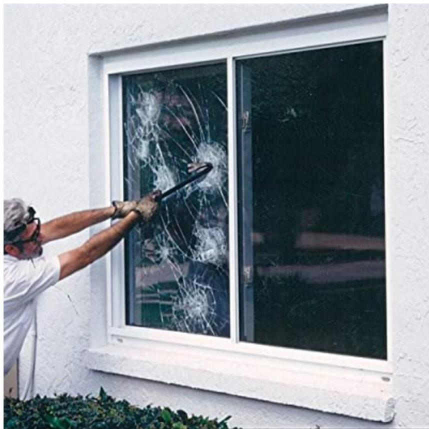
Slika 11. Predodžba protuprovanih prozora
