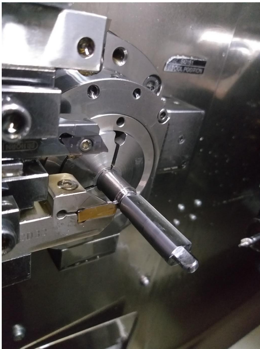
Slika 28 Operacija oslobodenja i natražno tokarenje
