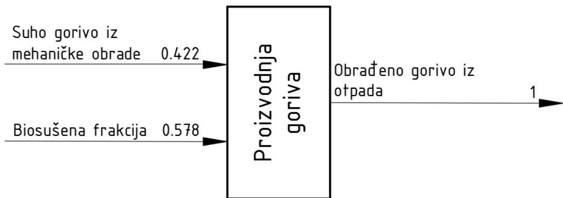
Slika 31. Shema postrojenja za proizvodnju krutog oporabljenog goriva sa prepostavljenim masenim udjelima
