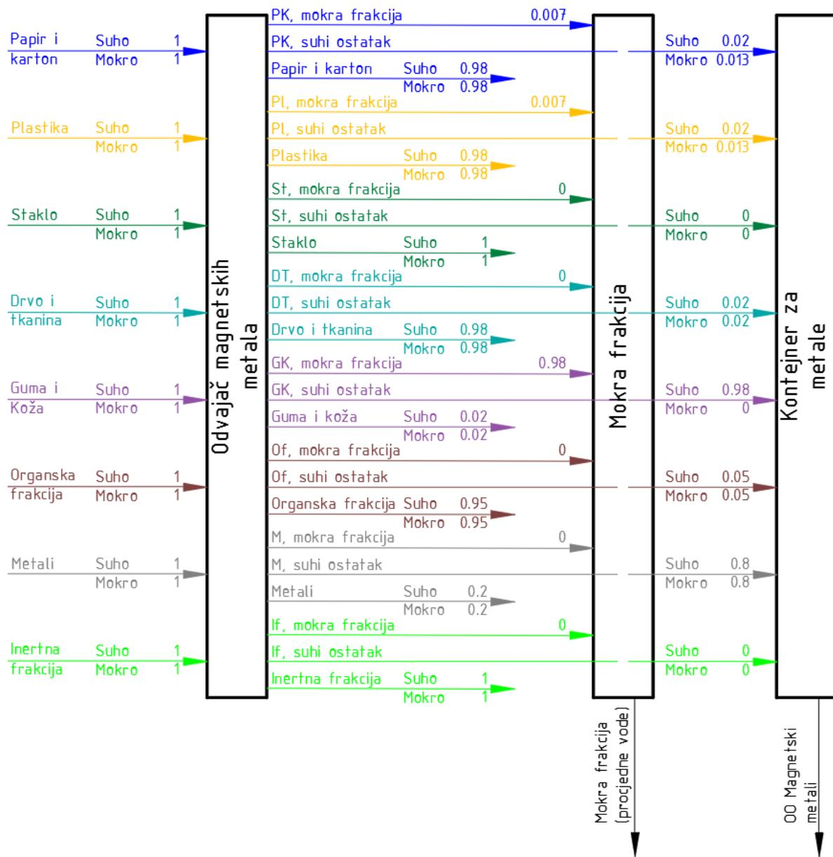
Slika 20. Shema magnetskog odvajača s prepostavljenim transfer koeficijentima
