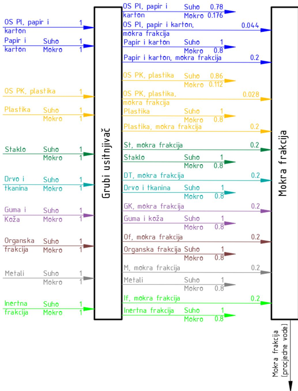
Slika 19. Shema grubog usitnjivača s prepostavljenim transfer koeficijentima
