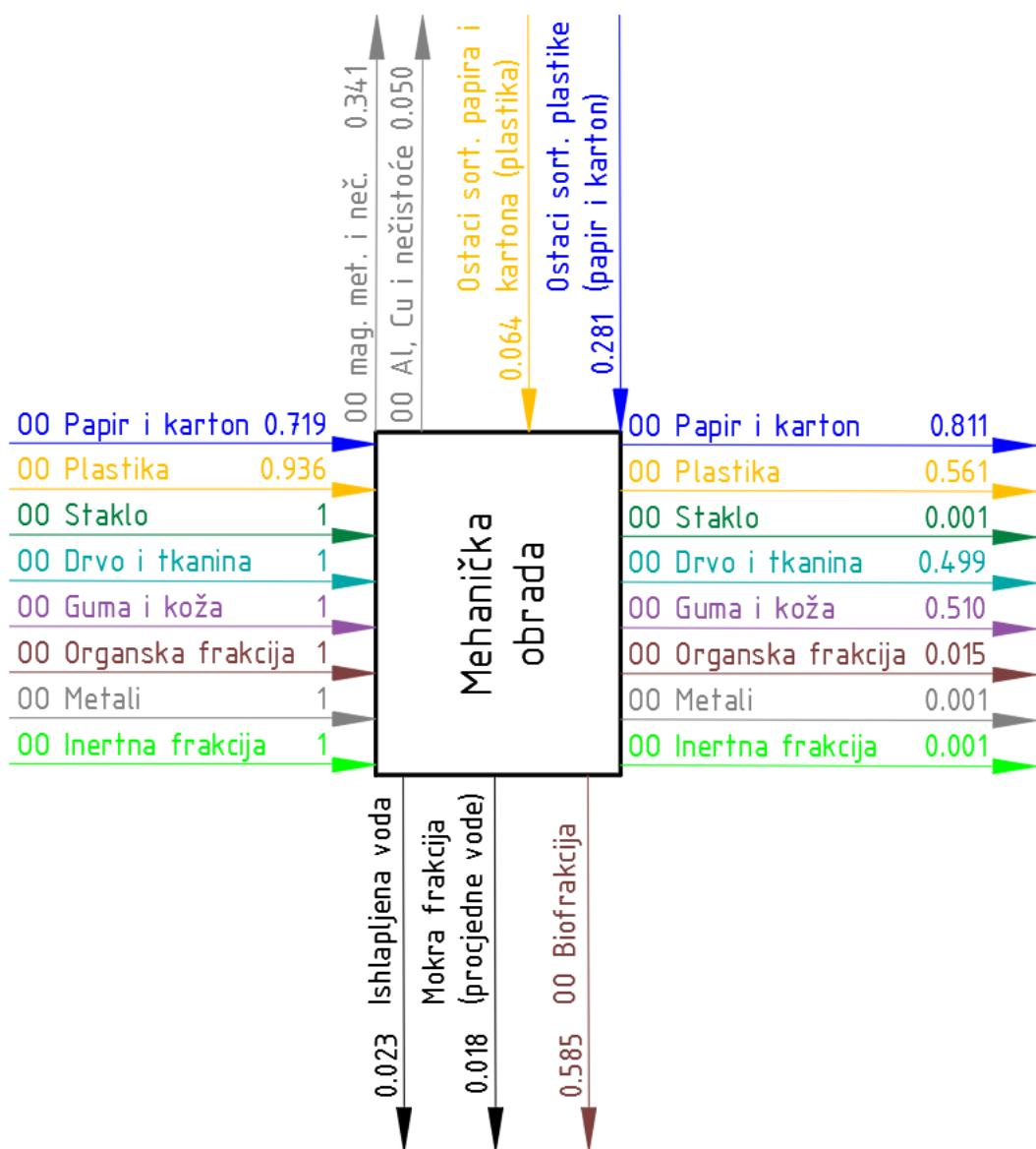
Slika 16. Shema mehaničke obrade sa koeficijentima masenog toka
