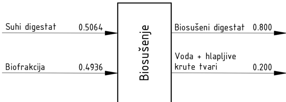
Slika 29. Shema postrojenja za biosušenje sa prepostavljenim transfer koeficijentima masenih tokova
