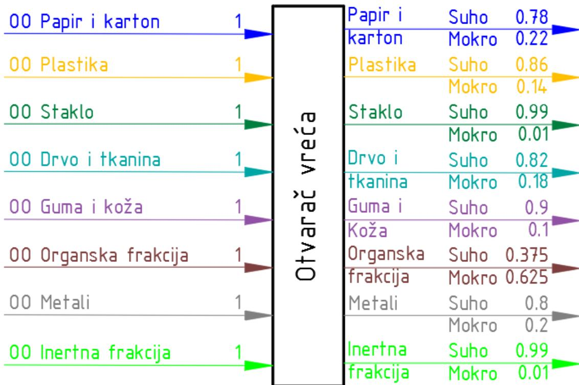
Slika 17. Shema otvarača vreća s prepostavljenim transfer koeficijentima
