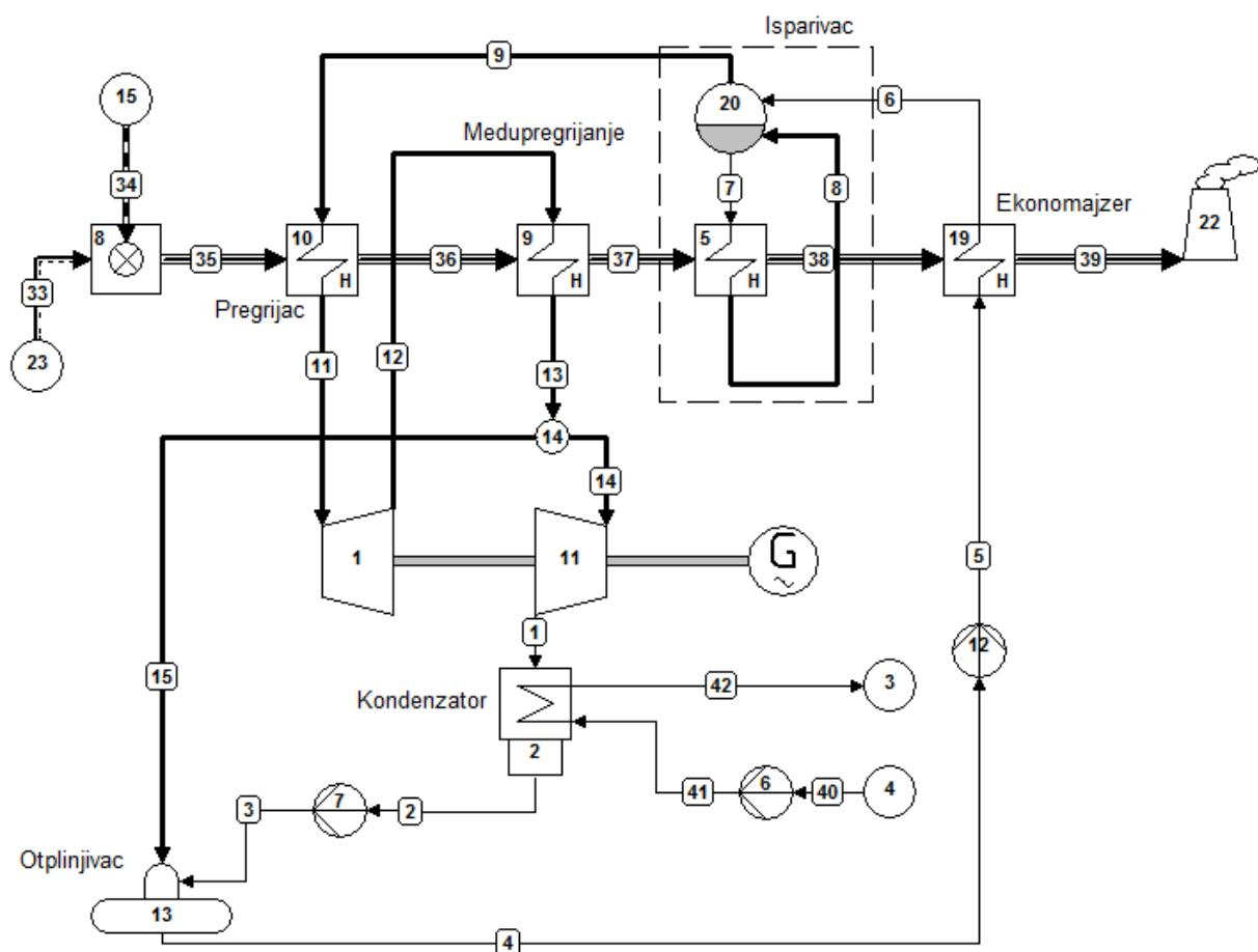
Slika 39. Shema osnovnog (referentnog) postrojenje s međupregrijanjem
