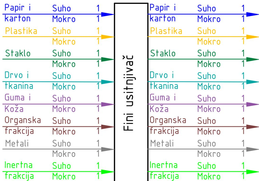
Slika 24. Shema finog usitnjivača s prepostavljenim transfer koeficijentima
