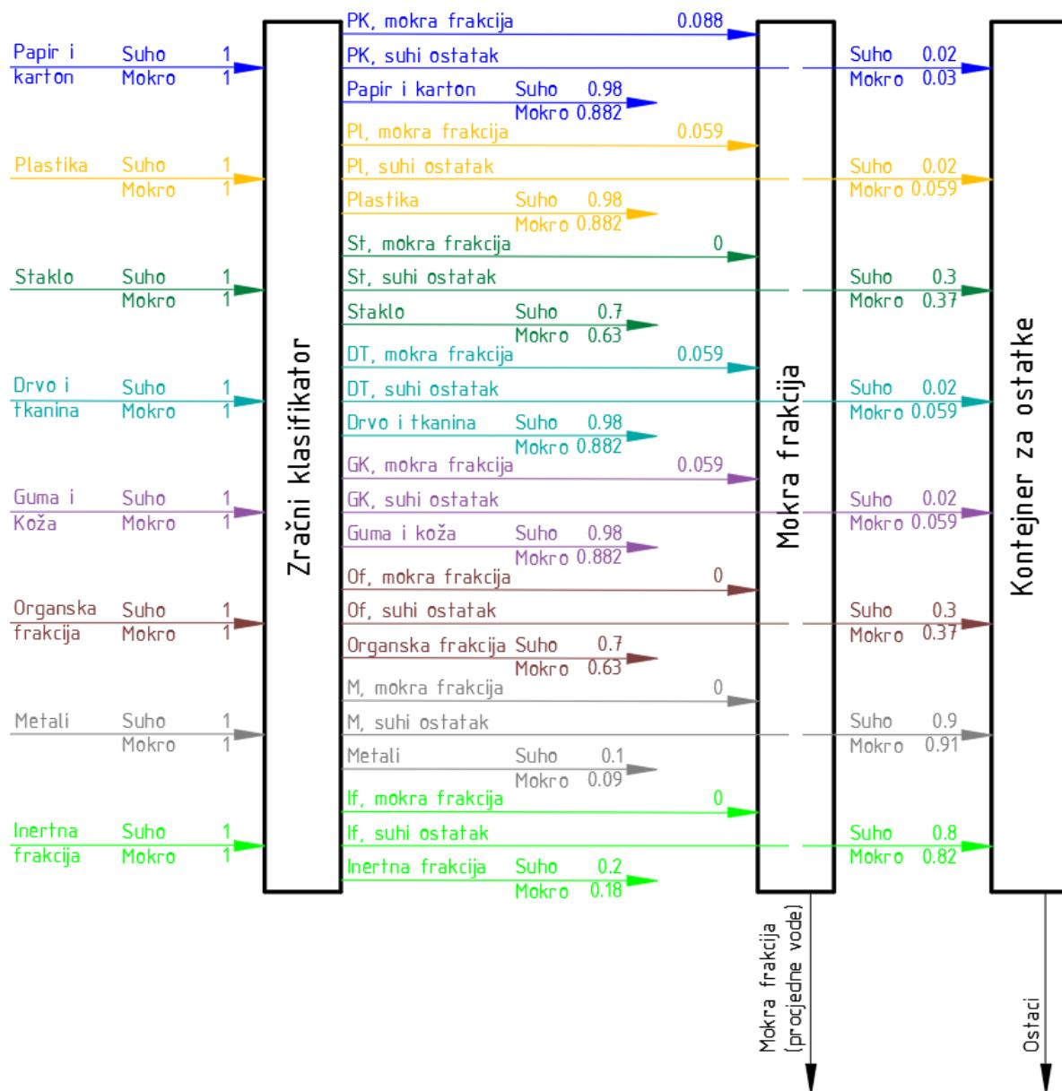
Slika 23. Shema zračnog klasifikatora s prepostavljenim transfer koeficijentima
