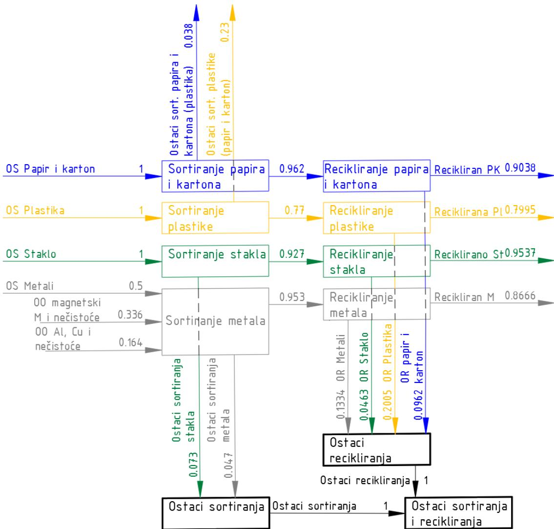
Slika 8. Shema postupaka sortiranja i recikliranja sa prepostavljenim transfer koeficijentima masenog toka
