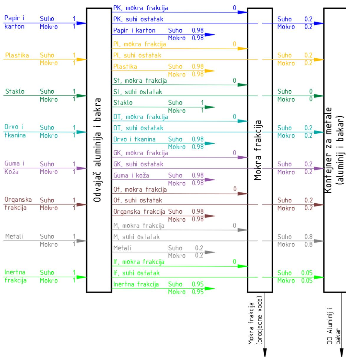
Slika 22. Shema odvajača aluminija i bakra s prepostavljenim transfer koeficijentima
