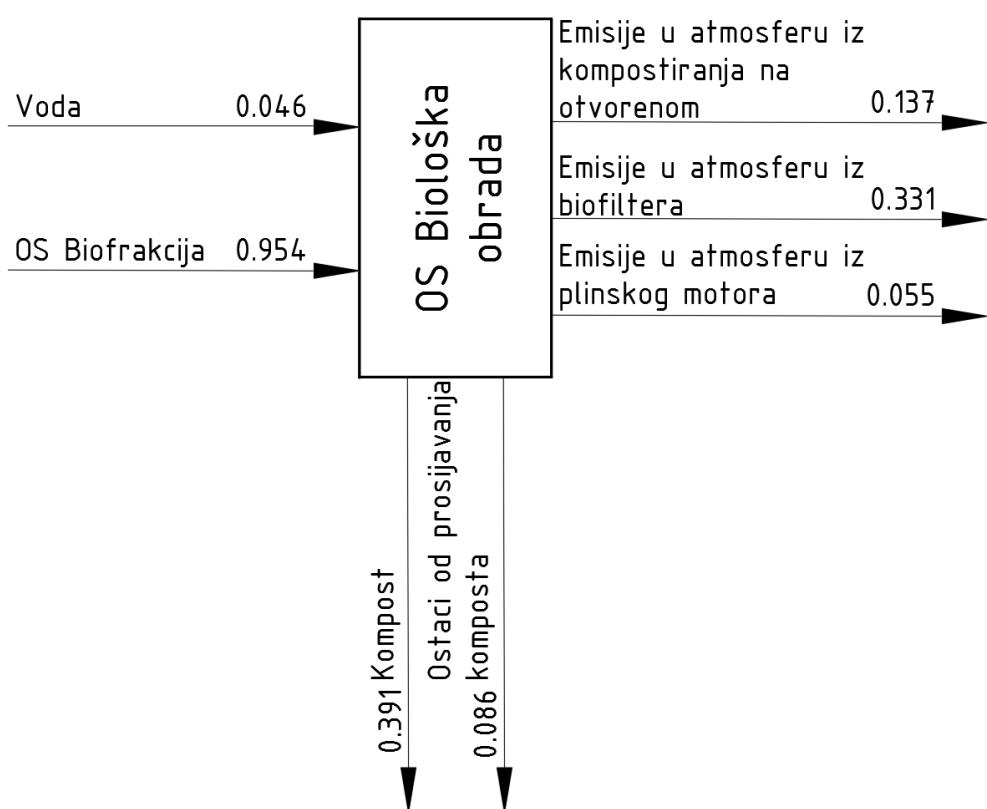
Slika 9. Shema postrojenja biološke obrade s prepostavljenim koeficijentima masenog toka
