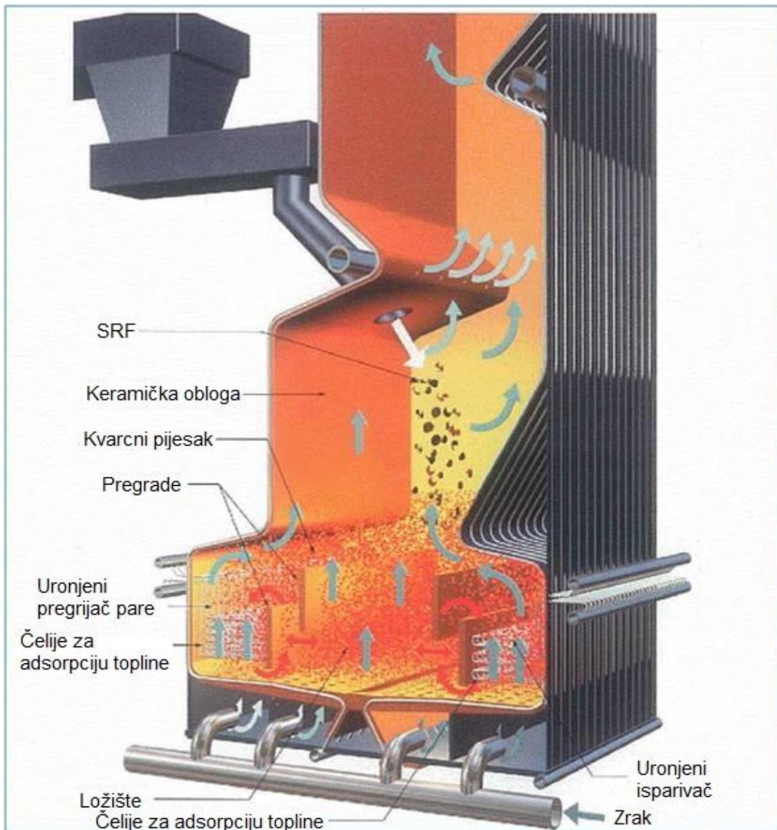
Slika 37. Ložište za izgaranje goriva u fluidiziranom sloju [21]
