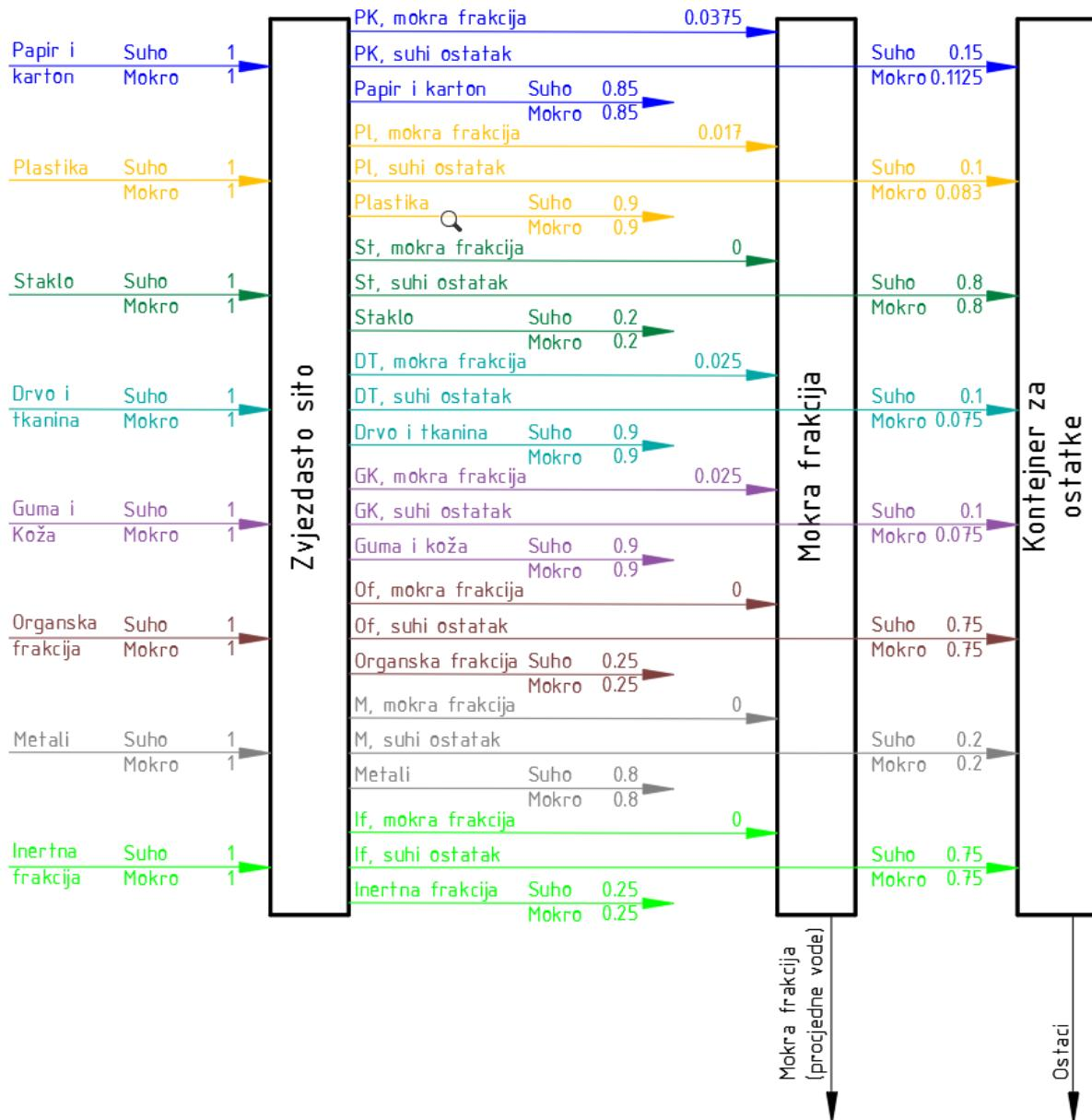
Slika 21. Shema zvjezdastog sita s prepostavljenim transfer koeficijentima
