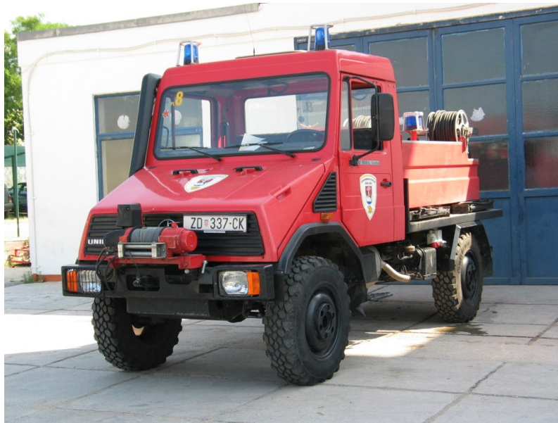
Sl. 34. Unimog U 100L za gašenje šumskih požara [23]
