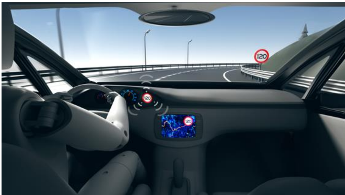
Slika 53. Predodžba korištenja SAS tehnologije automatskog postavljanja brzine preko očitavanja znaka sa ceste ili kartografskih digitalnih podataka, izvor: www.euroncap.com/en/vehicle-safety/the-ratings-explained/safety-assist/speed-assistance/ [47]
