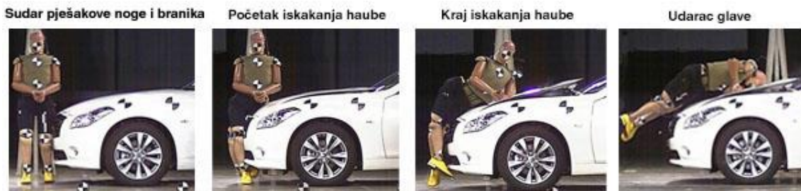
Slika 36. Predodžba načina rada pop-up haube, Mazda, izvor: www.nissan-global.com/EN/TECHNOLOGY/OVERVIEW/puehfpp.html [39]
