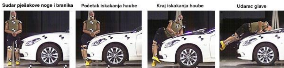
Slika 36. Predodžba načina rada pop-up haube, Mazda, izvor: www.nissan-global.com/EN/TECHNOLOGY/OVERVIEW/puehfpp.html [39]
