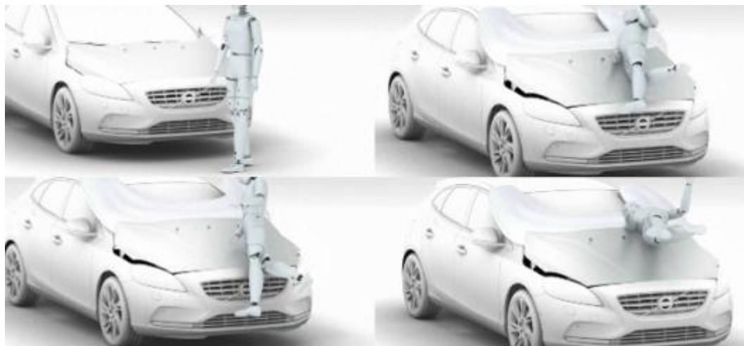
Slika 37. Predodžba rada vanjskog zračnog jastuka na Volvu V40, prvom automobilu koji je njime opremljen, izvor: volvocars.com (2013.) [40]
