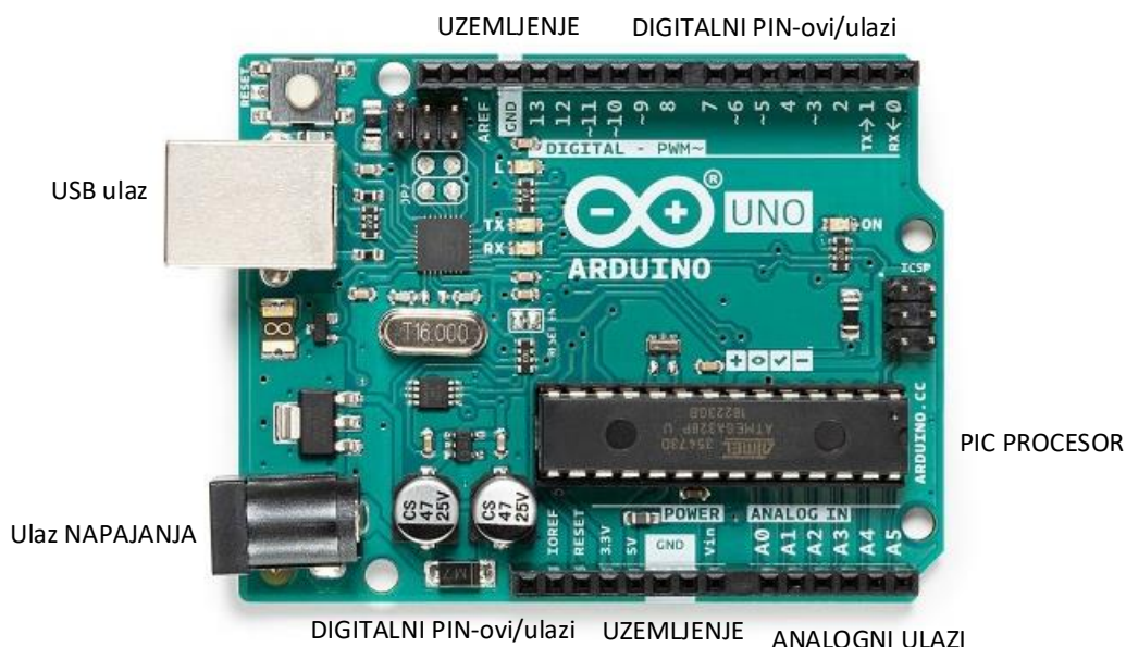
Slika 12. Vizualni prikaz Arduino upravljačke jedinice
