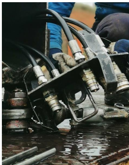
Slika 65. Fleksibilni hidraulični vodovi i brze spojke
