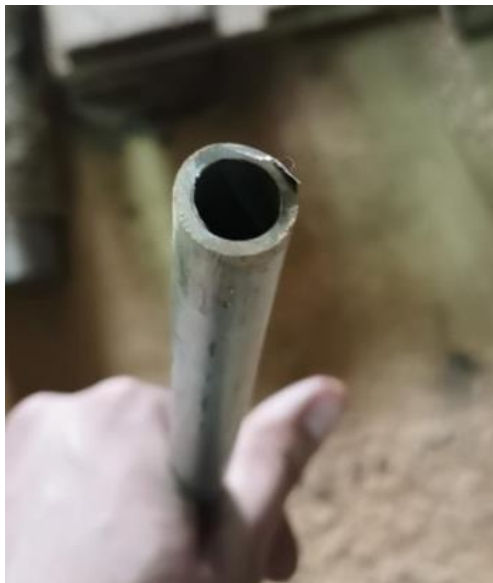
Slika 69. Čelična bešavna cijev
