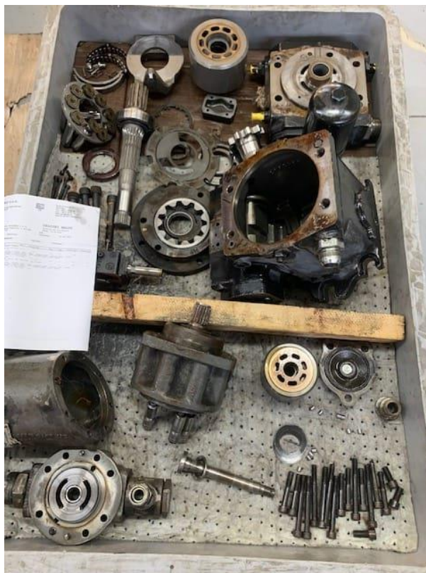
Slika 51. Pumpa rastavljena na dijelove
