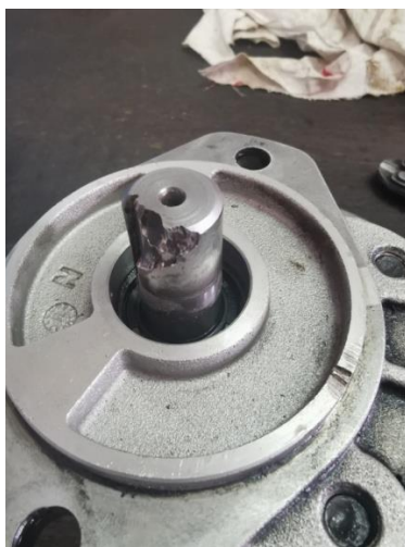
Slika 52. Oštećenje osovine pumpe
