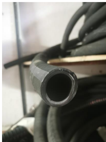
Slika 25. Fleksibilni hidraulični cjevovod jednostruko armiran čeličnom mrežicom
