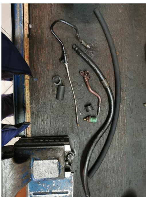
Slika 66. Promjena fleksibilnog hidrauličnog voda na servo crijevu
