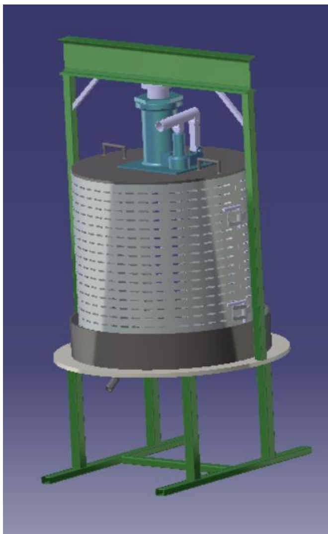
Slika 50. Preša sa hidrauličnom dizalicom (3D model).
