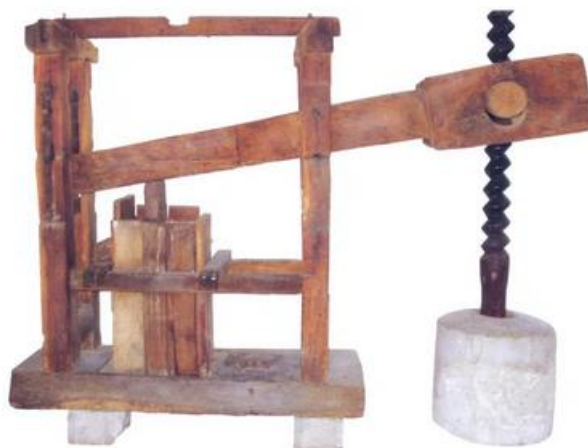
Slika 2. Horizontalna preša sa kamenom. [20]
