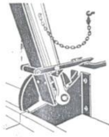
Slika 10. – Uređaj za ograničenje gibanja klatne pile
