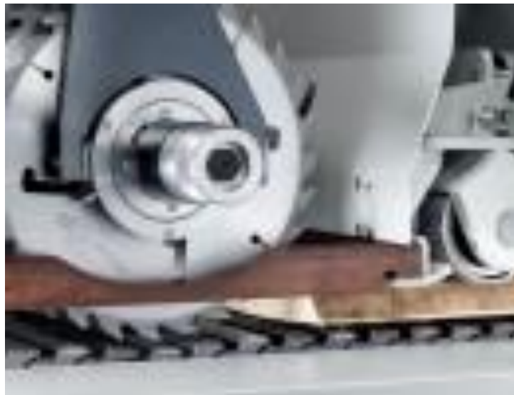
Slika 18. – Pomična zaštita na radnom dijelu trake
