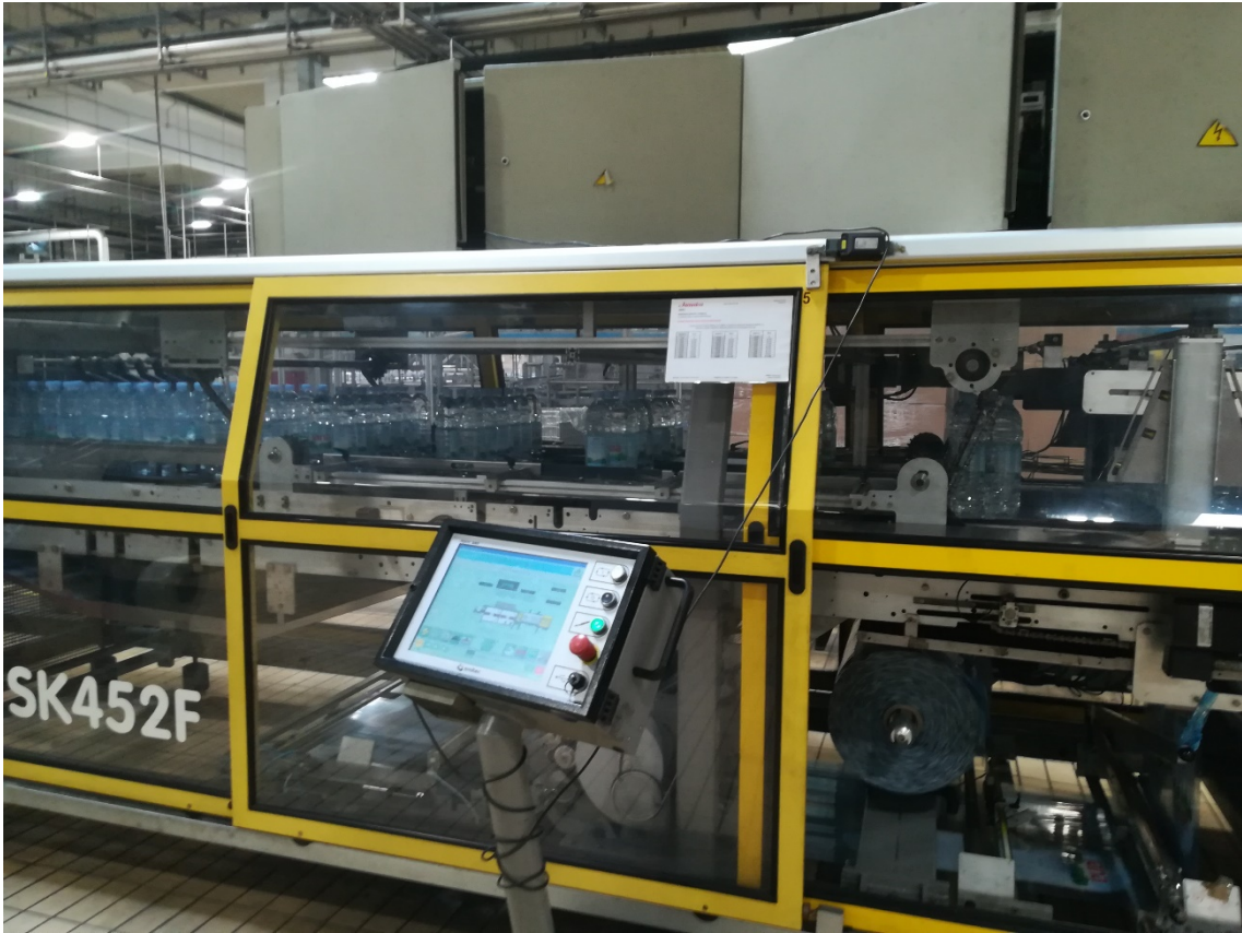
Slika 20. Centralni pult za upravljanje strojem.
