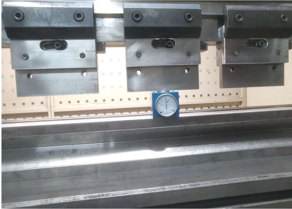
Slika 39. Mjerenje visine prihvatnika žiga
