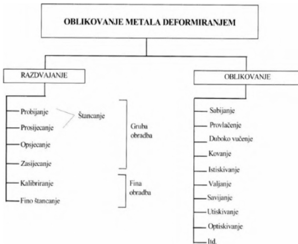
Slika 1. Podjela postupaka oblikovanja deformiranjem [3]
