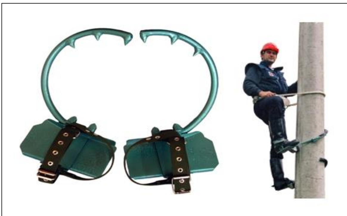
Sl. 10. Penjalice i njihova primjena na drvenim stupovima [5]
