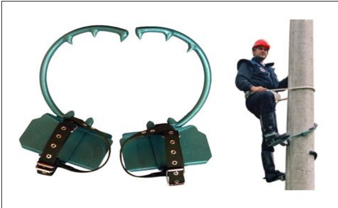
Sl. 10. Penjalice i njihova primjena na drvenim stupovima [5]
