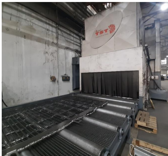
Slika 11. Stroj za sačmarenje
