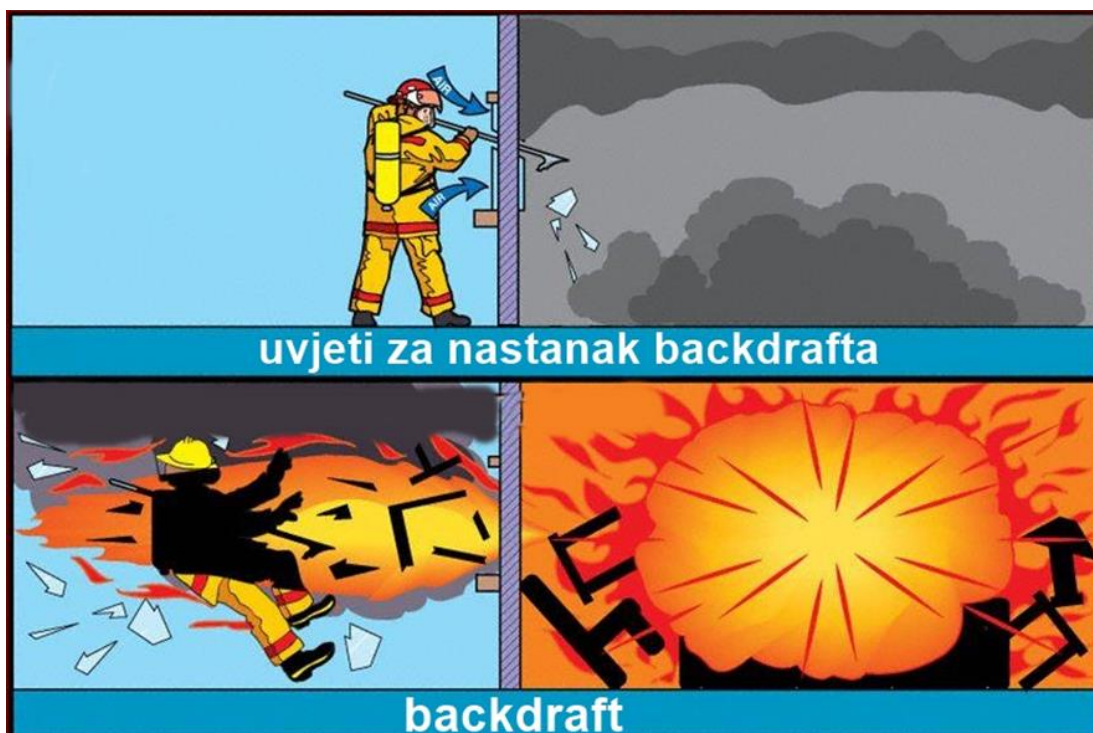
Slika 7. Neoprezan ulazak u prostor, u kojem vladaju uvjeti za nastanak backdrafta, rezultirati će eksplozijom [16]
