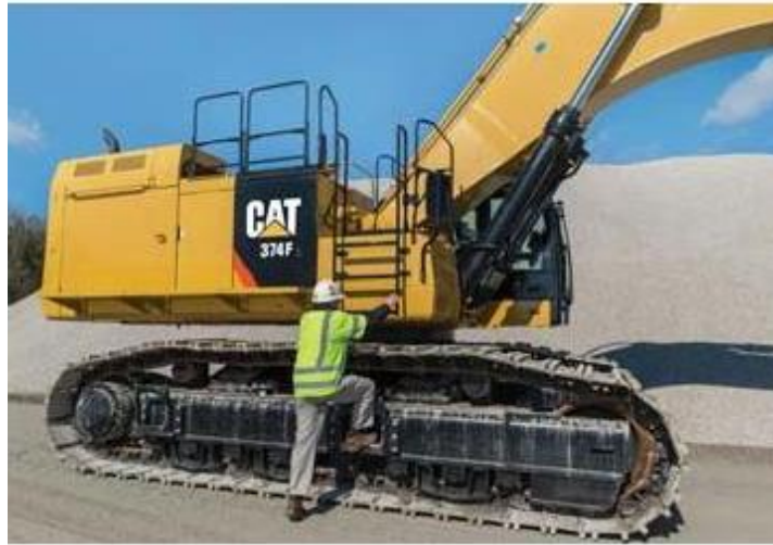
Slika 20. d Zaštitna naprava na velikom bageru pristupna stepenica
