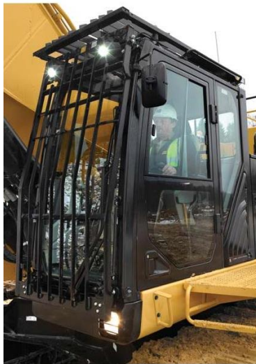
Slika 20. b Zaštitna naprava na velikom bageru metalni štitnik kabine
