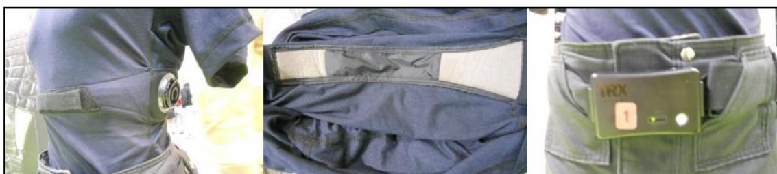
Sl. 19. Fiziološki senzori i lokator WASP tehnologije [21]
