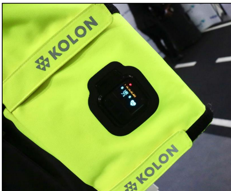
Sl. 26. Očitavanje senzora na rukavu jakne [25]
