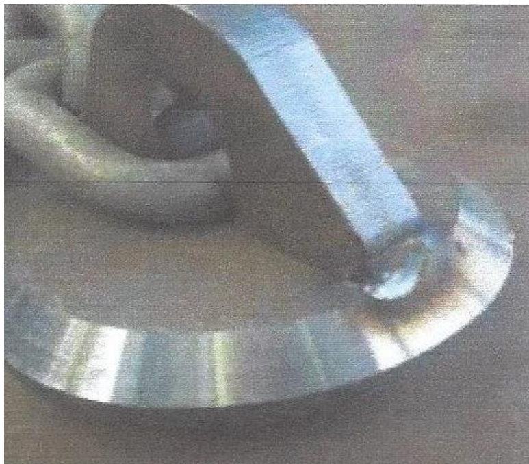
Slika 30. Pripajanje uške na disk [11]
