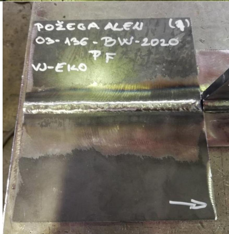
Slika 42. Epruveta- || zavarivač [12]
