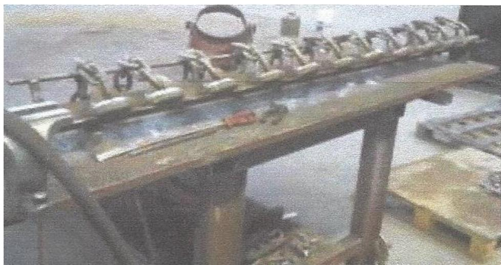
*Slika 31. Naprava za završno zavarivanje [11]*
