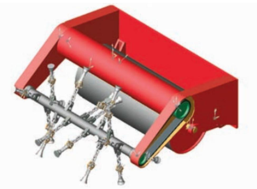
*Slika 4. Osnovni dizajn radnog alata- mlatilo [4]*
