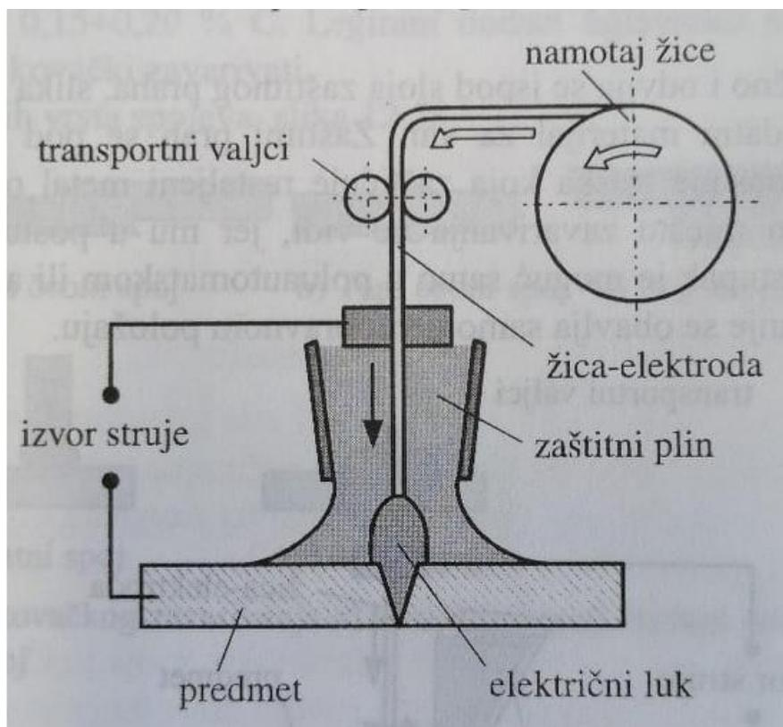
Slika 13. Shematski prikaz MAG postupka zavarivanja [10]
