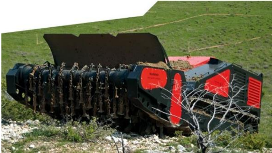
Slika 1. Stroj za razminiranje s mlatilicama [9]
