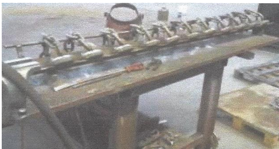
Slika 31. Naprava za završno zavarivanje [11]
