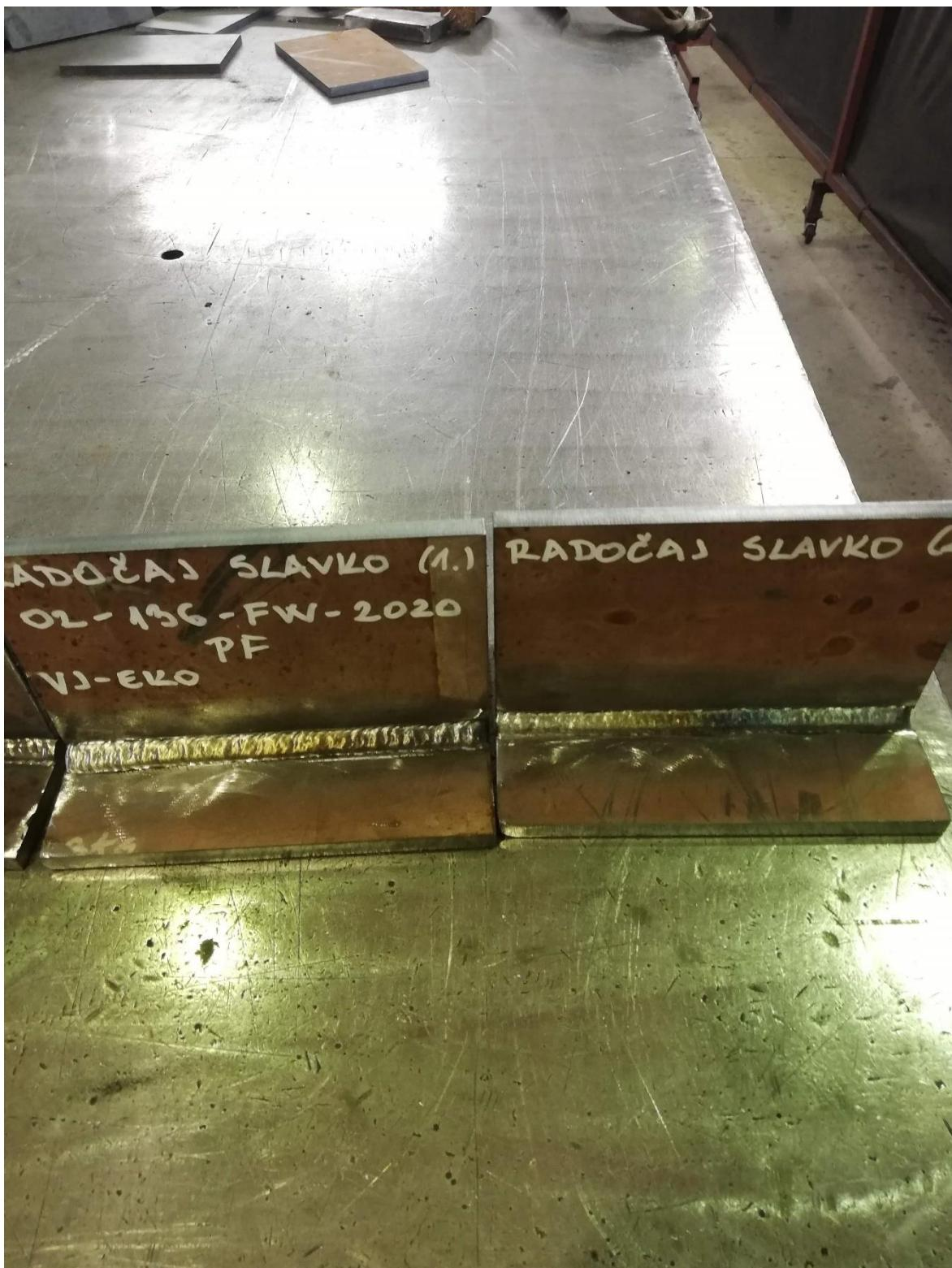
Slika 44. Epruveta- III zavarivač [12]
