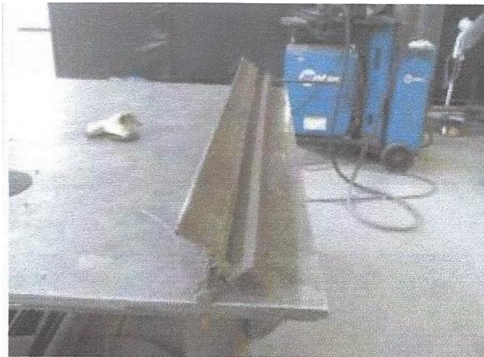
Slika 25. Naprava za završno zavarivanje [11]
