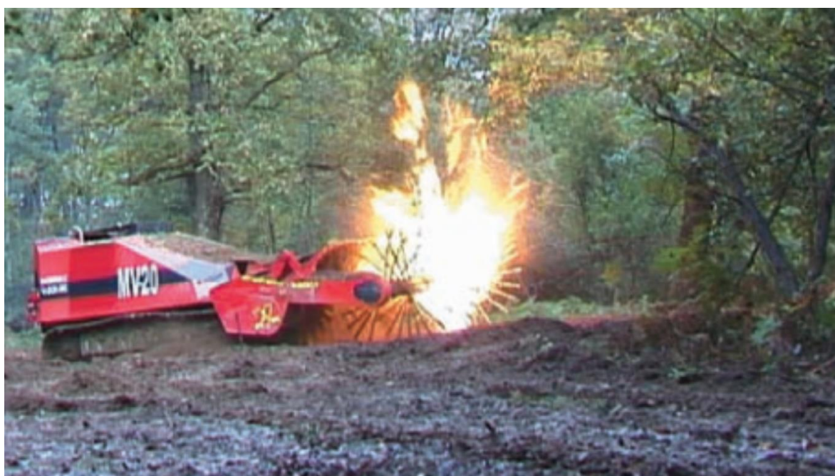
Slika 11. Detonacija mine ispod mlatila [4]
