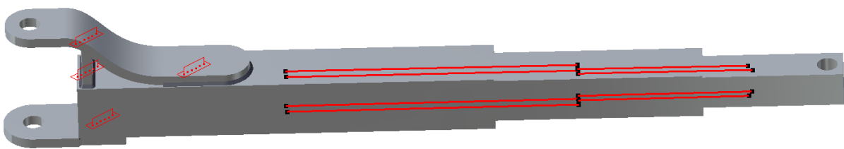
Slika 36. Spojevi zavarivanjem i kontaktni spojevi
