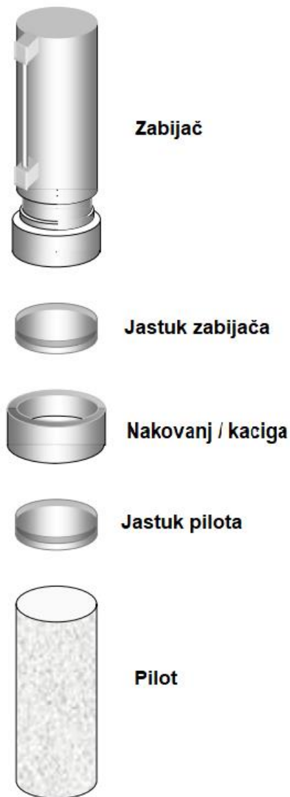
Slika 14. Sustav zaštite pilota [22]
