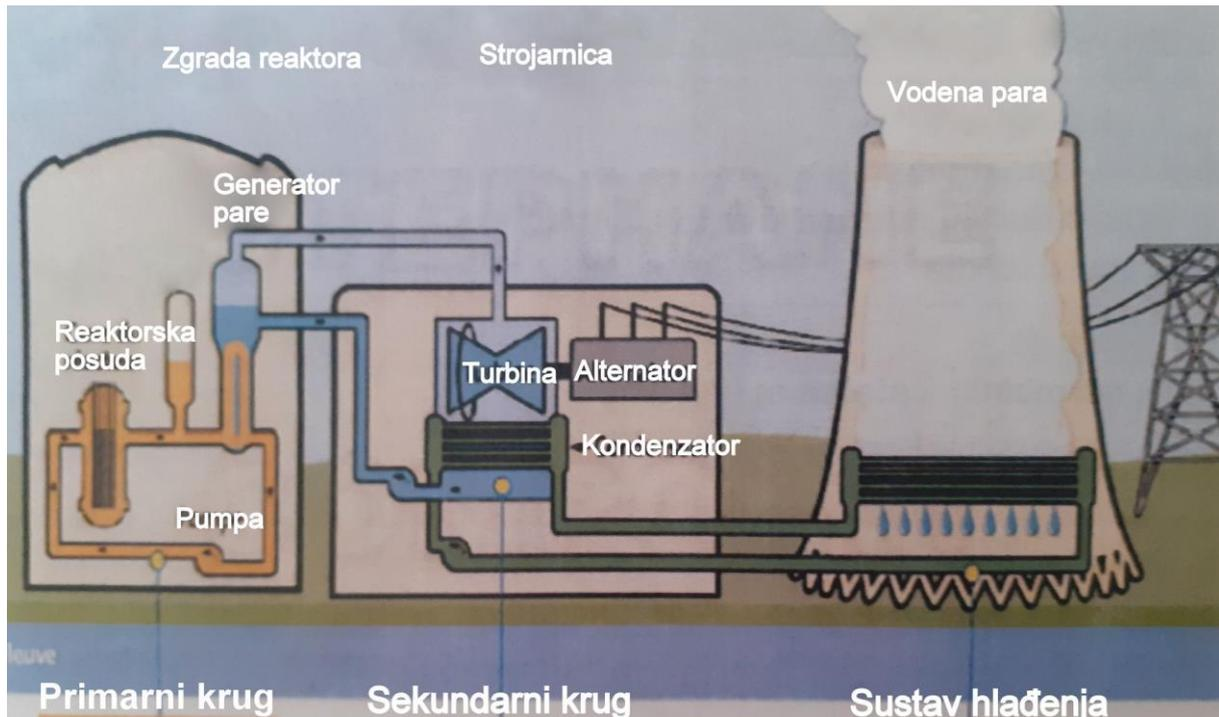
Slika 2. Pojednostavljeni prikaz rada tlačnog reaktora [10]
