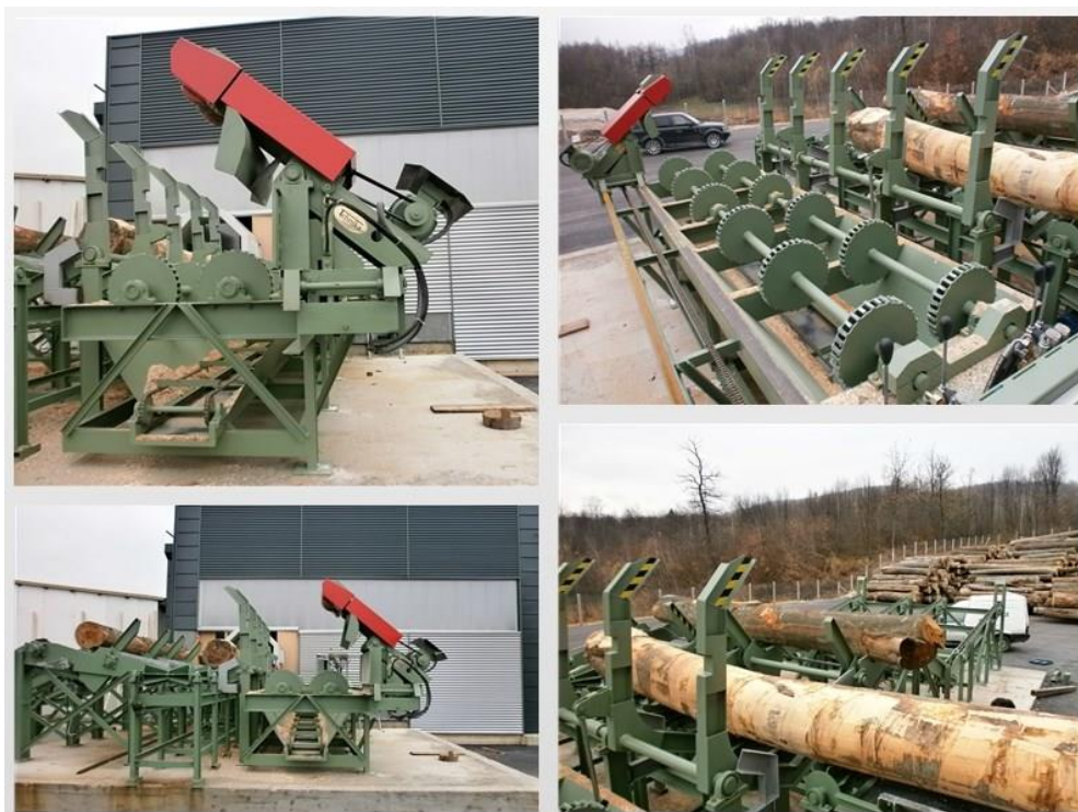
Slika 17. Proces skidanja kore trupca [17]
