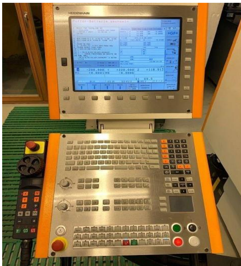
Slika 26. Upravljačka jedinica Heidenhain iTNC 530
