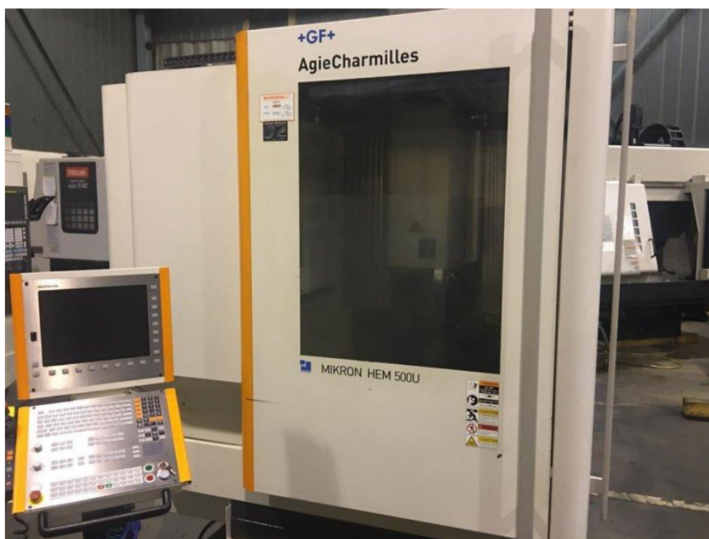
Slika 24. CNC glodalica Mikron HEM 500U
