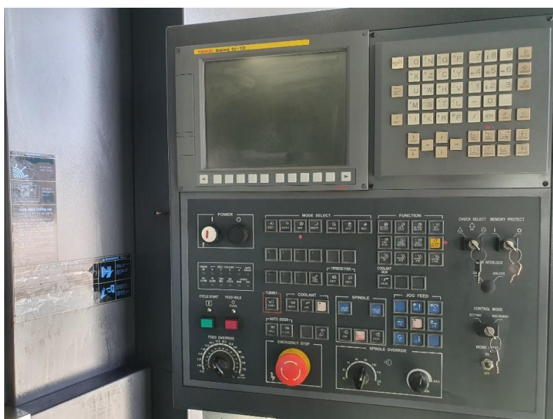
Slika 23. Upravljačka jedinica Fanuc 0i-TD
