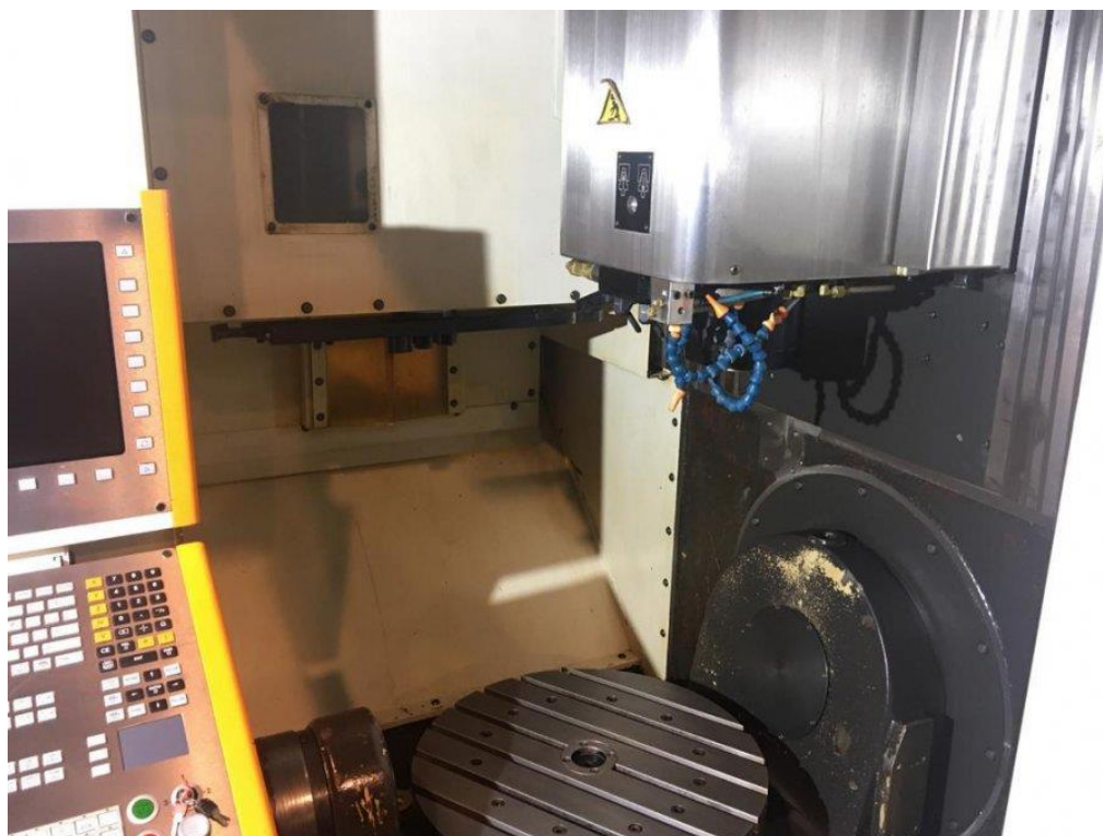
Slika 25. Unutrašnjost CNC glodalice Mikron HEM 500U
