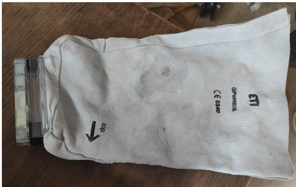
Slika 13 Zaštitna rukavica za mijenjanje osigurača
