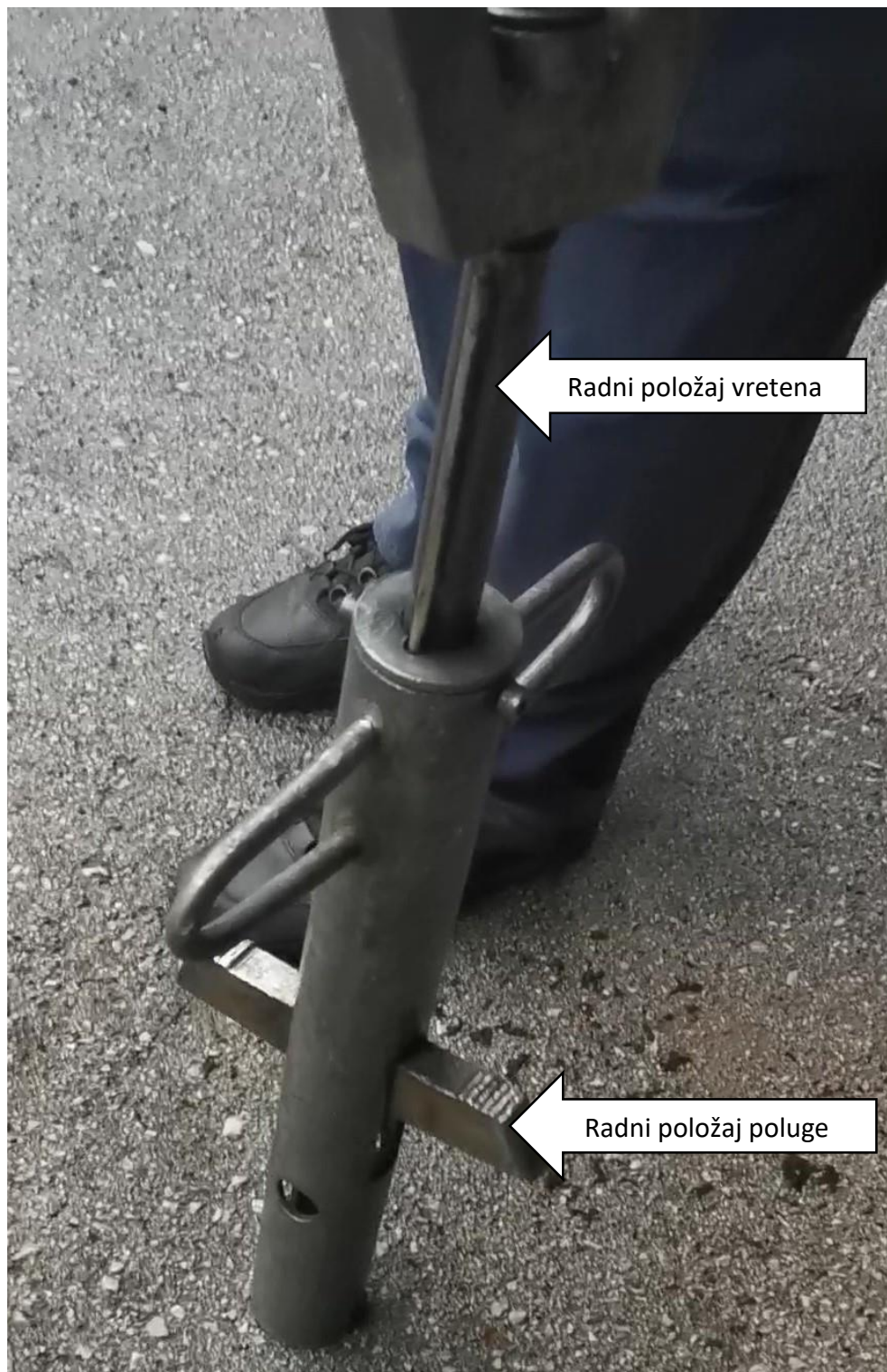
Slika 19. Vreteno izvučeno do kraja i poluga u horizontalnom položaju
