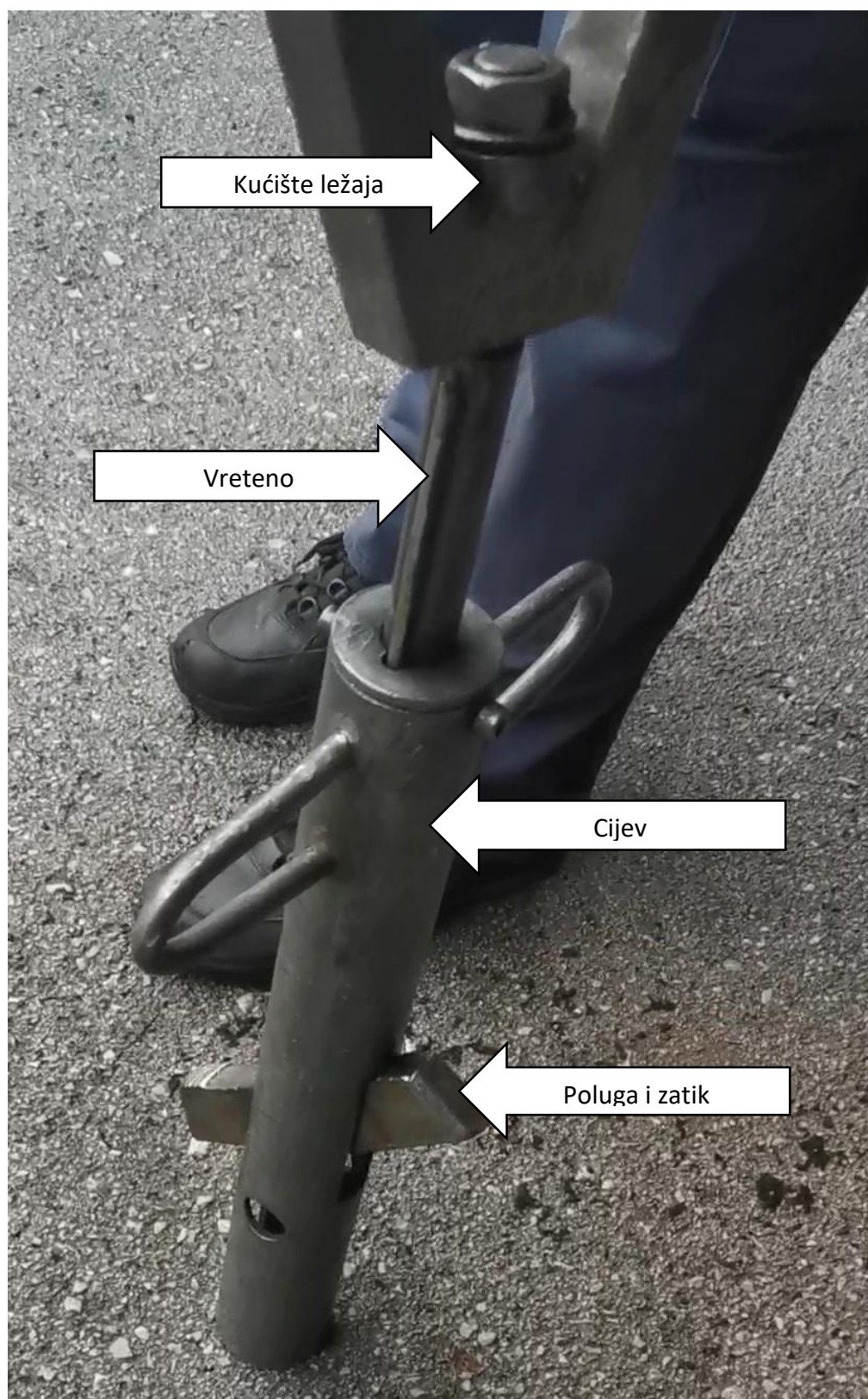
Slika 18. Izvlačenje vretena i izlazak poluge iz cijevi
