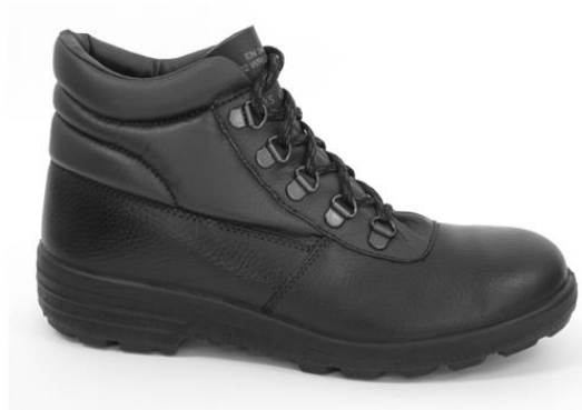
Slika 30. Visoke cipele sa zaštitnom kapicom i pur potplatom. Izrađene od goveđe kože. Izuzetno otporne na habanje. U prednji dio ugrađena je čelična kapica sa zaštitom od udara od 200J.
