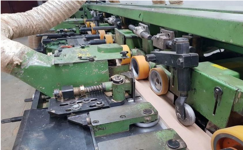
Slika 26. Primjer pomičnih hidrauličkih vretena (Stolarija Jakopčin)
