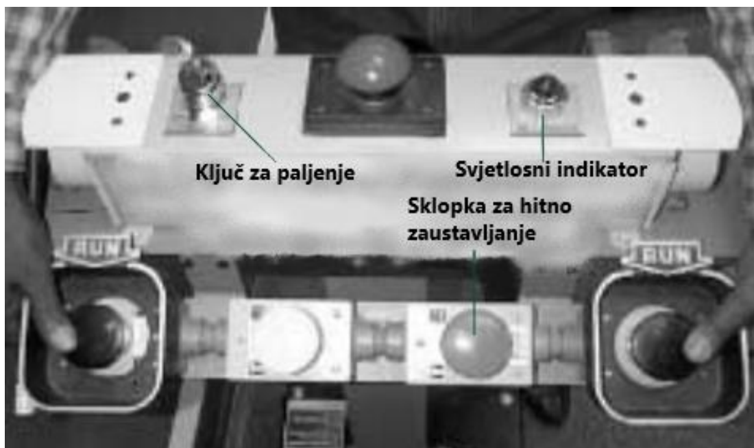
Slika 10. Primjer dvoručnog sustava za pokretanje hidrauličke preše [5]
