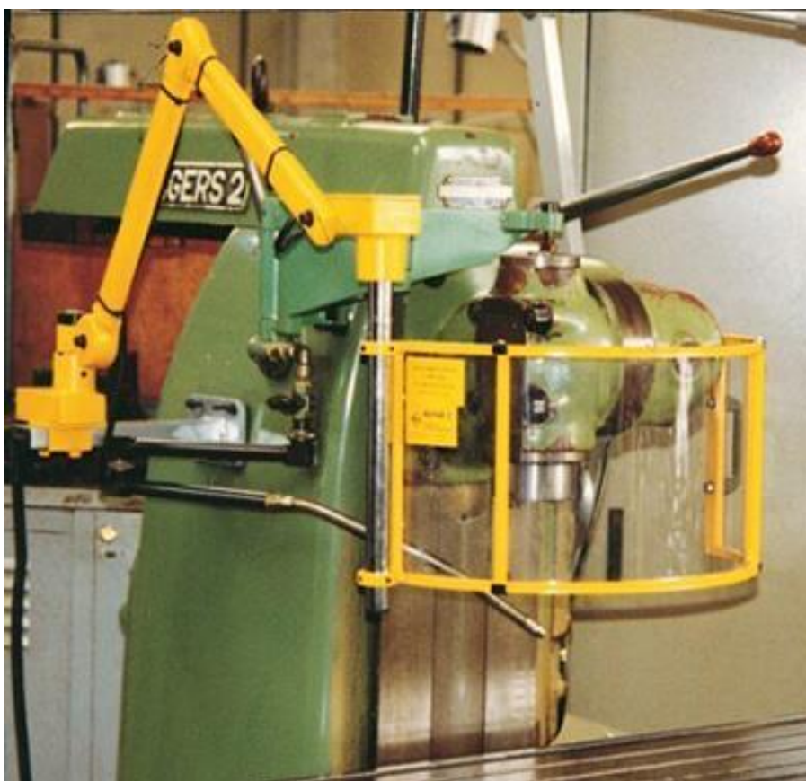
Slika 8. Primjer pomične zaštitne naprave na glodalici pokretljive u svim smjerovima (Stolarija Jakopčin)
