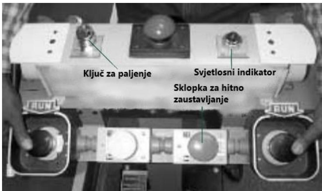
Slika 10. Primjer dvoručnog sustava za pokretanje hidrauličke preše [5]
