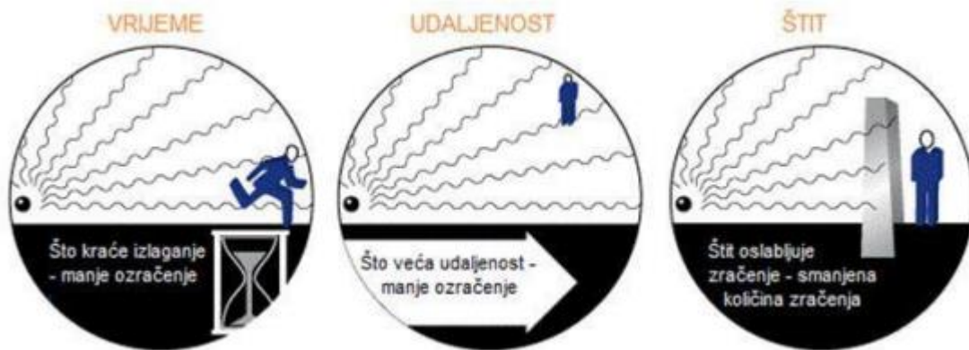
Slika 25. Osnovni načini zaštite od rendgenskog zračenja
