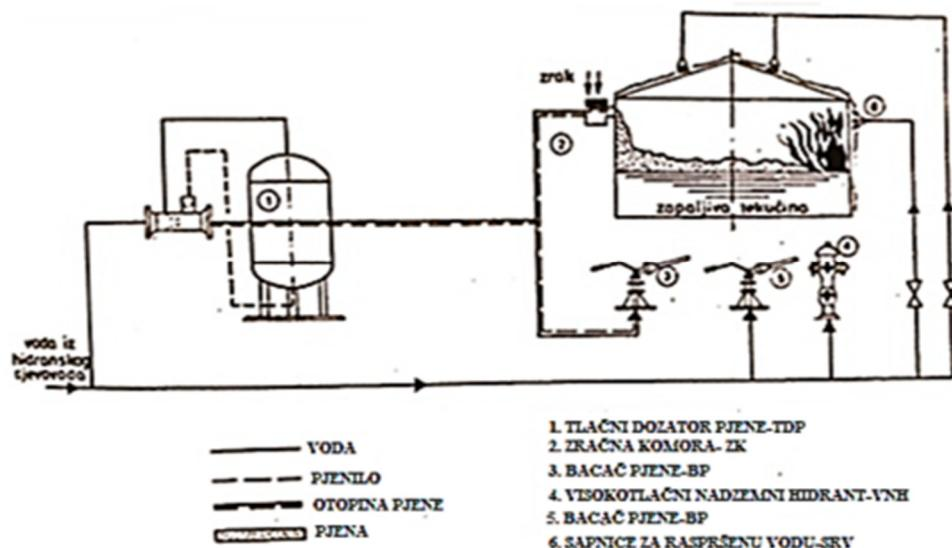
Slika 8. Shema rada tlačnog dozatora pjene [4]
