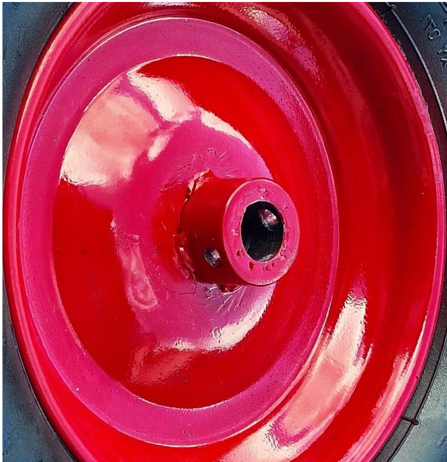
Slika 47 – Prikaz navlake zavarene na središte kotača.
