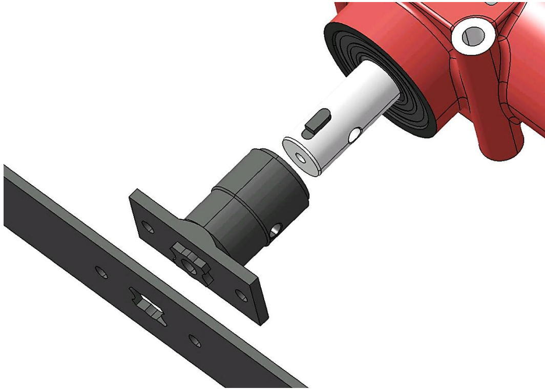
Slika 67 – 3D eksplodiran prikaz noža, adaptera noža i osovine kutnog reduktora.
