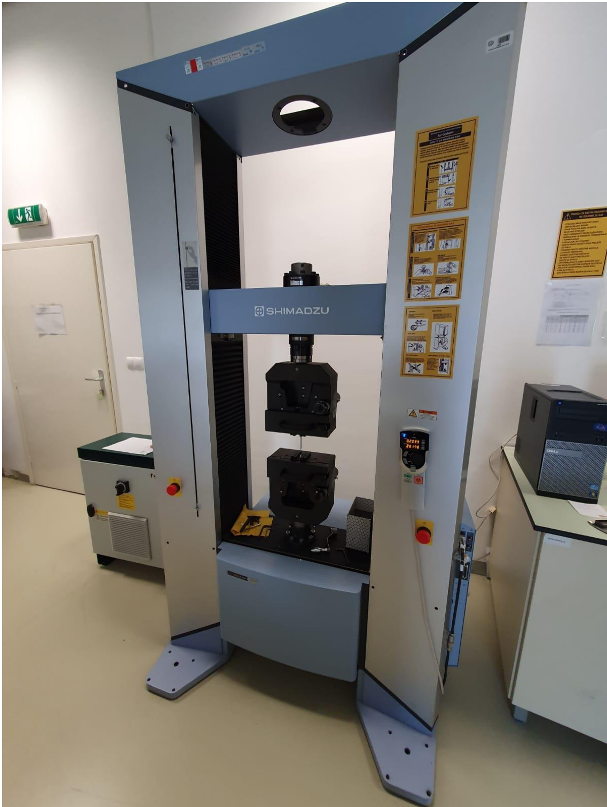
Slika 26. Prikaz Shimadzu AG-X kidalice
