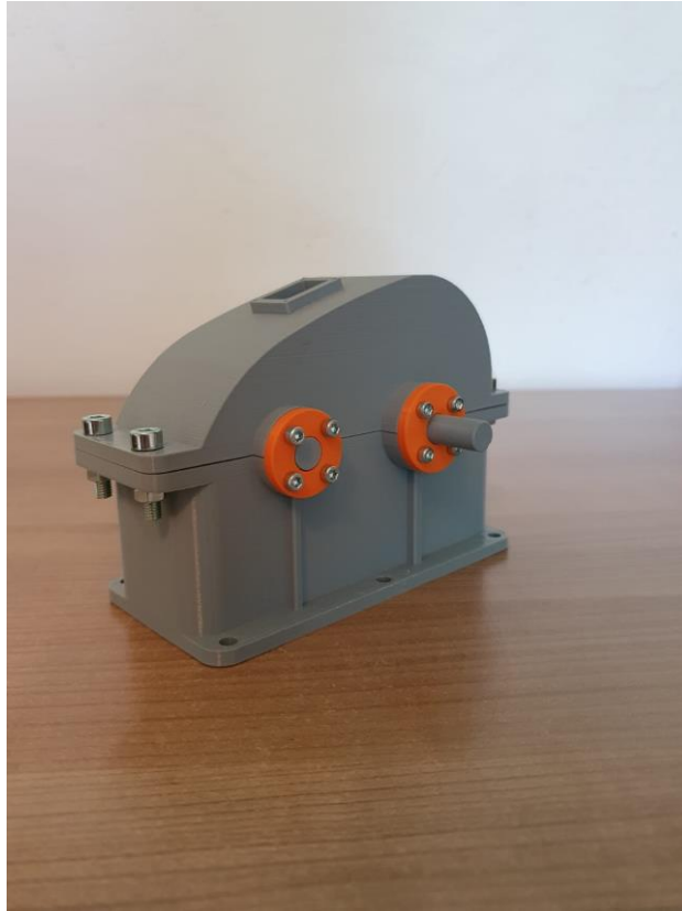
Slika 1. Primjer reduktora izrađenog FDM / FFF tehnologijom
