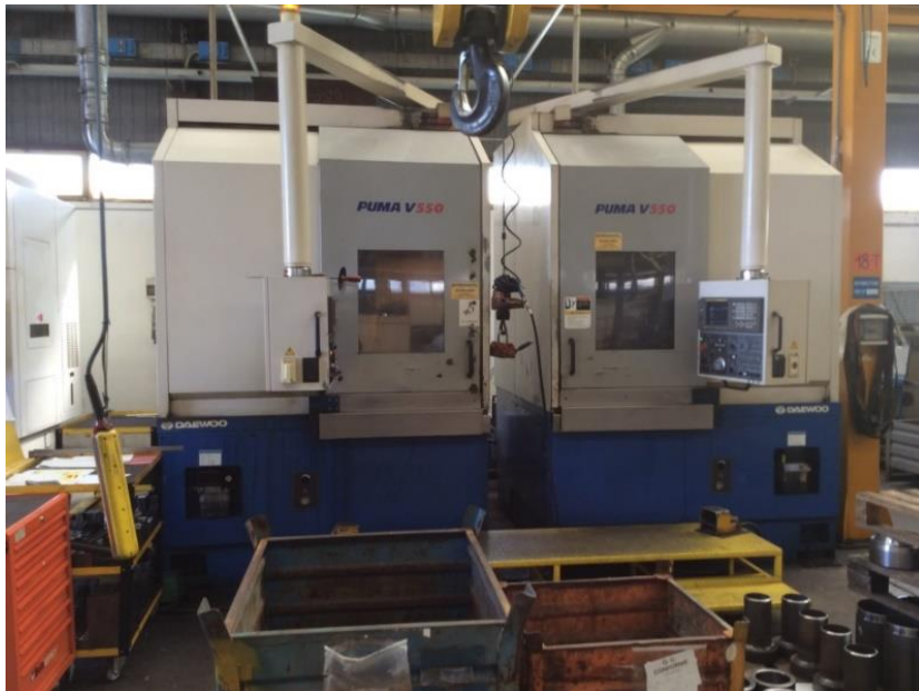
Slika 31.: CNC tokarilica Daewoo puma v550[10]
