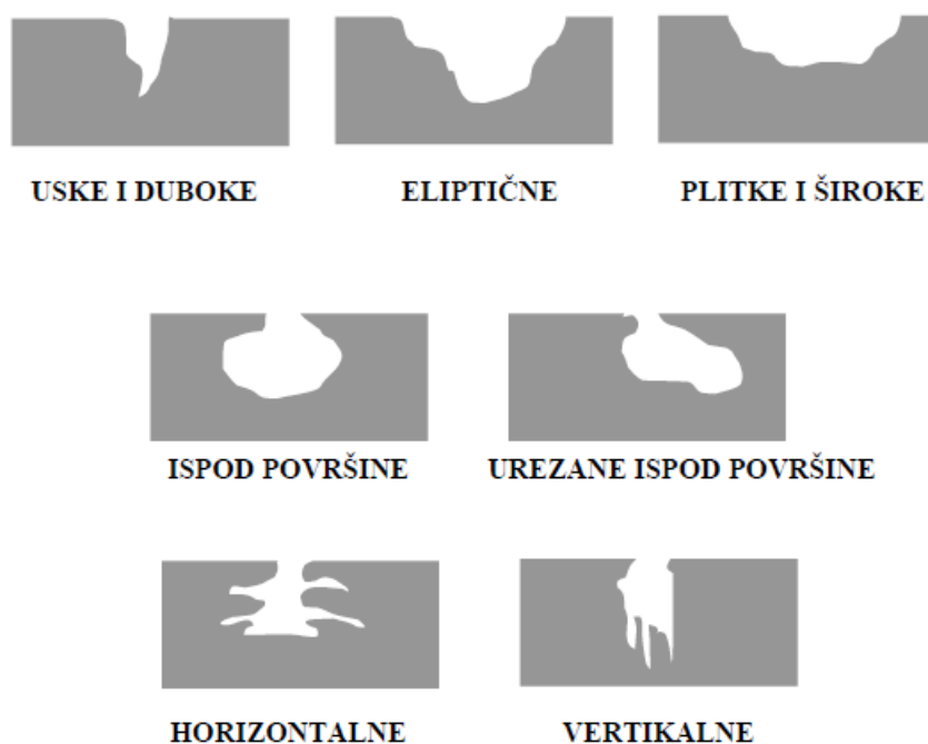
Slika 2. : Oblici točkaste- jamičaste korozije
