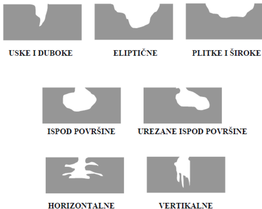
Slika 2. : Oblici točkaste- jamičaste korozije
