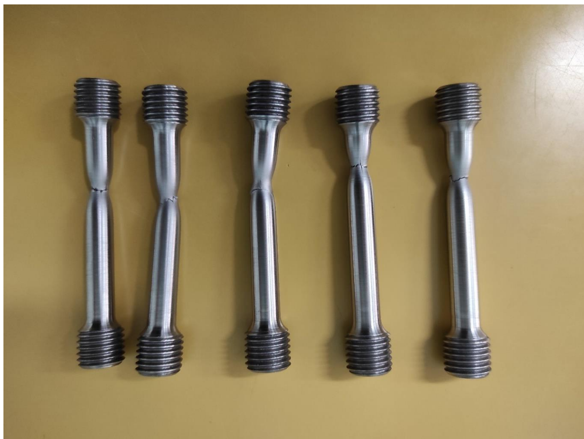
Slika 28. : Prikaz epruveta nakon provedenog statičkog vlačnog ispitivanja
