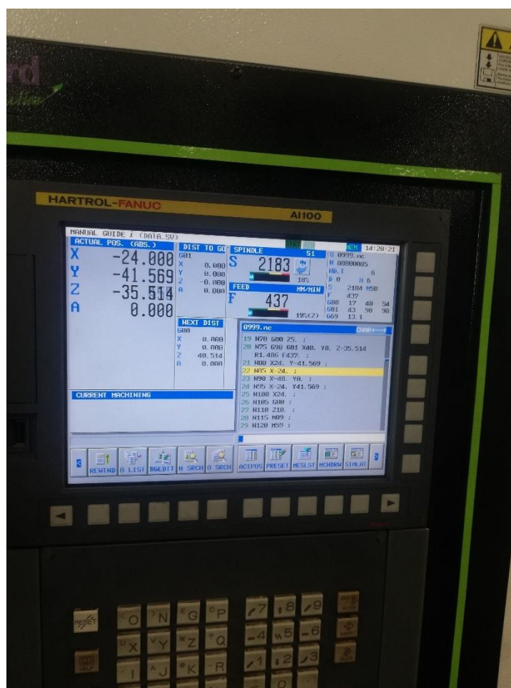
Slika 49. Upravljačka jedinica na CNC stroju
