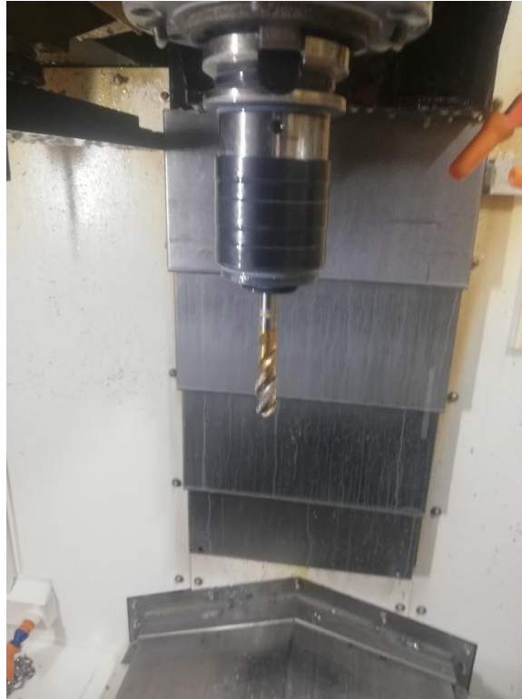
Slika 50. Ureznik HSS-E sa TiN presvlakom
