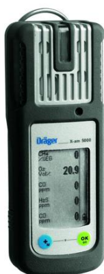
Slika 6: Uređaj za mjerenje koncentracije amonijaka u zraku 70
