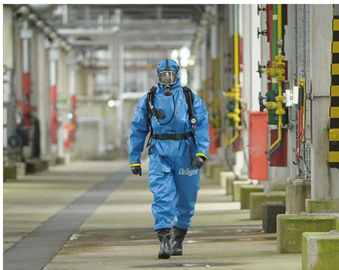
Slika 9: Potpuna zaštita osobe kod većeg istjecanja amonijaka 76
