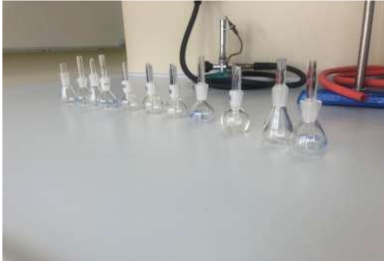
Slika 6. Piknometri korišteni za određivanje gustoće otopina.
