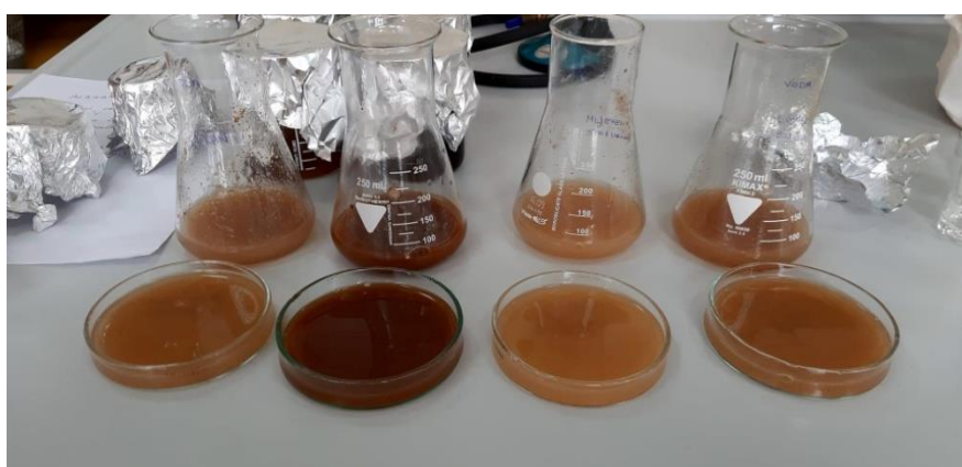
Slika 8. Izlijevanje otopina pektina s rogačem u Petrijeve zdjelice.
