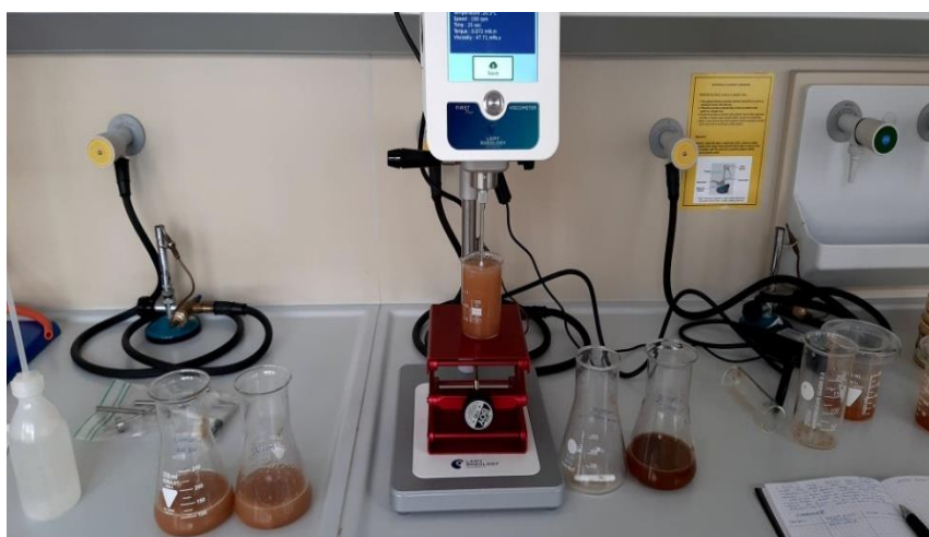
Slika 7. Mjerenje viskoznosti otopina.
