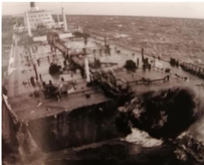
Slika 2. Primjeri brodoloma zbog korozije [1].
