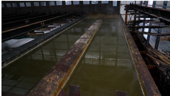
Slika 34. Kada za odmašćivanje[7]
