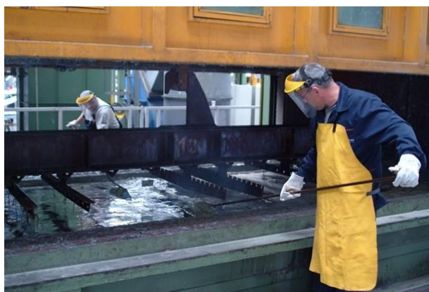
Slika 38. Kada za pocinčavanje prije izvlačenja predmeta [6]
