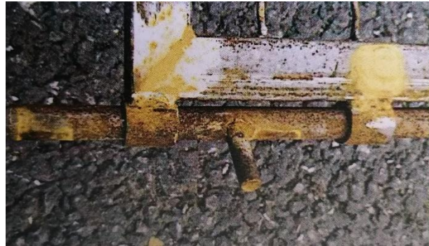
Slika 48. Pokretni dijelovi se ne mogu pocinčavati zajedno [8]
