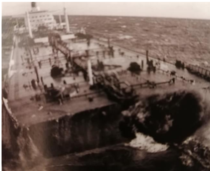
Slika 2. Primjeri brodoloma zbog korozije [1].
