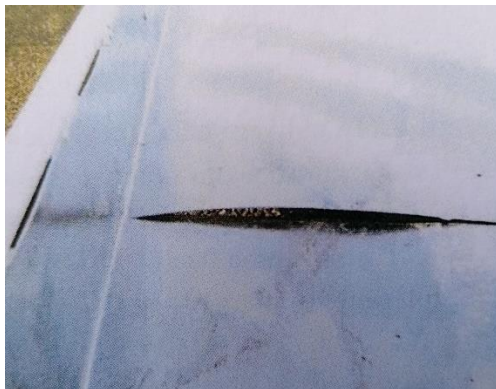
Slika 49. Toplinske deformacije lima [8]
