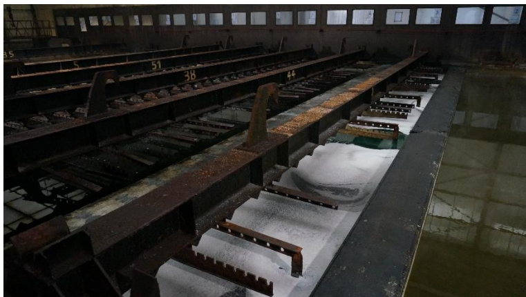
Slika 35. Kade za nagrivanje i ispiranje [7]
