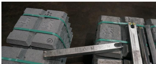
Slika 39. Blokovi Zn i legure Al i Zn za nadomještanje potrošene taline [7]
