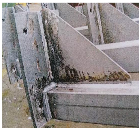
Slika 44. Loša kvaliteta prevlake uzrokovana sprejom za zavarivanje[8]
