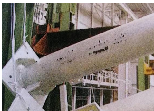
Slika 45. Nedostaci na prevlaci uzrokovani ostacima boje[8]
