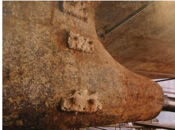
Slika 6. Opća korozija podvodnog dijela brodskog trupa [1]
