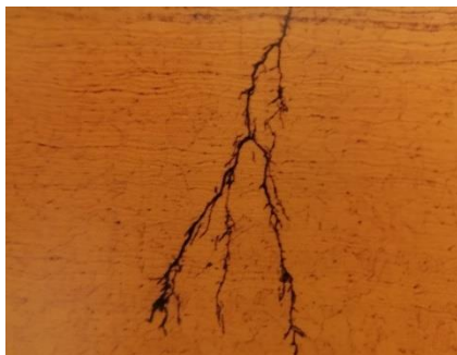
Slika 4. Primjeri drugih korozijskih oštećenja [1]
