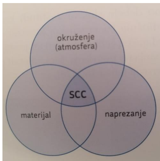
Slika 11. Čimbenici koji utječu na pojavu napetostne korozije[1].
