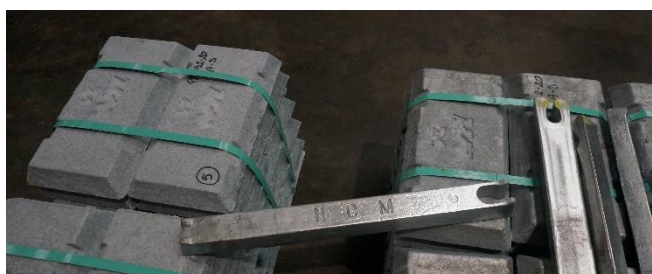
Slika 39. Blokovi Zn i legure Al i Zn za nadomještanje potrošene taline [7]
