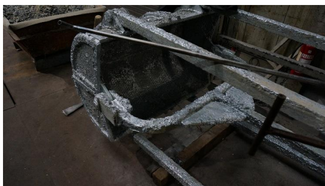
Slika 40. Košara za izvlačenje tvrdog cinka[7]
