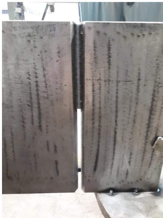
Slika 15. Zavareno s prvom elektrodom
