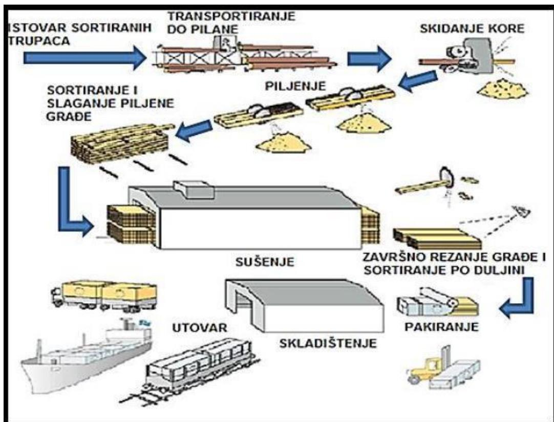
Slika 8: Prikaz proizvodnog procesa u pilani [21]
