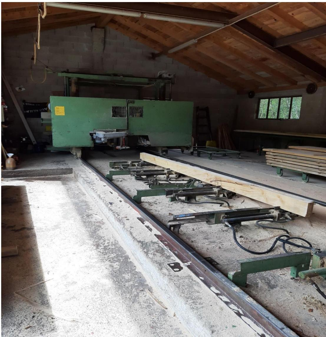
Slika 17: Tračna pila
