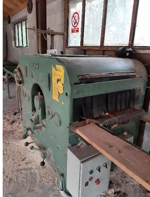
Slika 16: Automatska višelisna kružna pila
