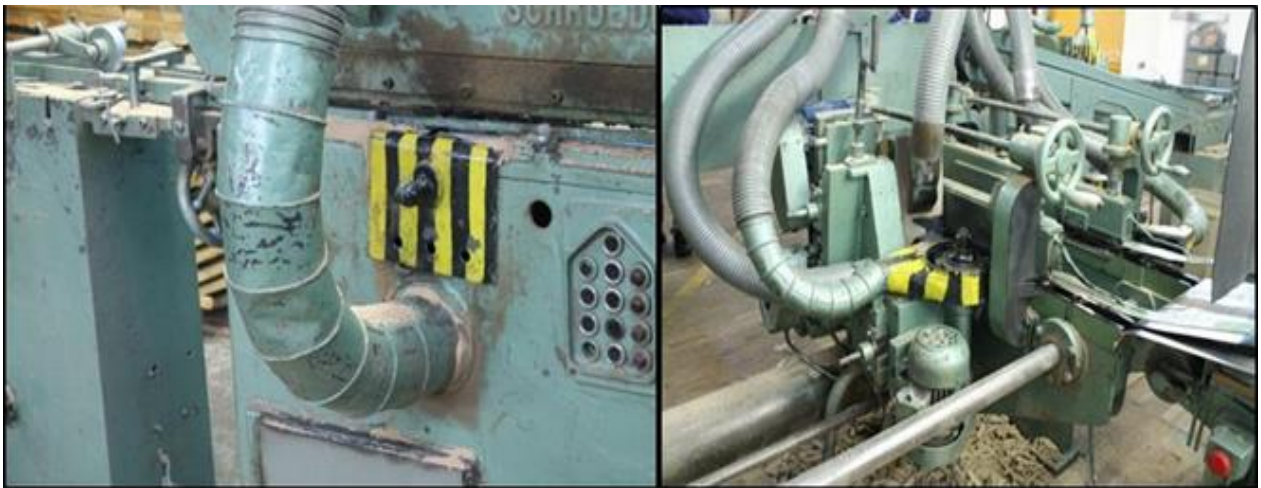
Slika 4: Lokalna ventilacija na mjestu stvaranja prašine
