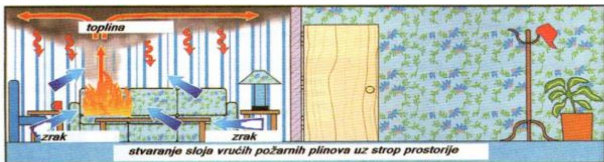
Slika 4. Povećanje temperature u području stropa od vrućih požarnih plinova [5]
