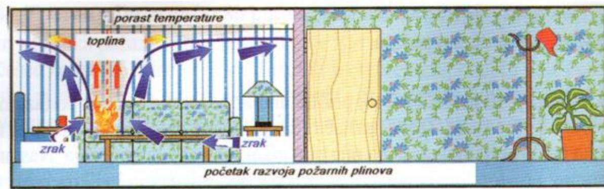
Slika 5. Pad temperature udaljavanjem od žarišta požara [5]
