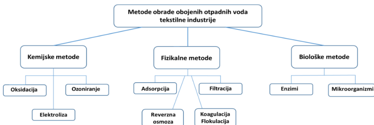
Slika 1. Metode uklanjanja bojila iz otpadnih voda
