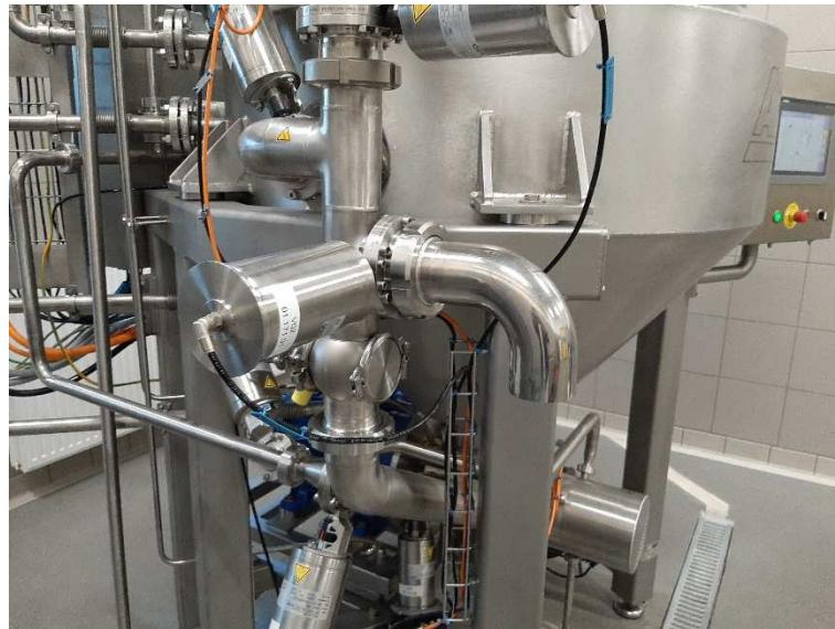
**Slika 15.** Ispust za gotov proizvod (Izvor: D. Novosel).
