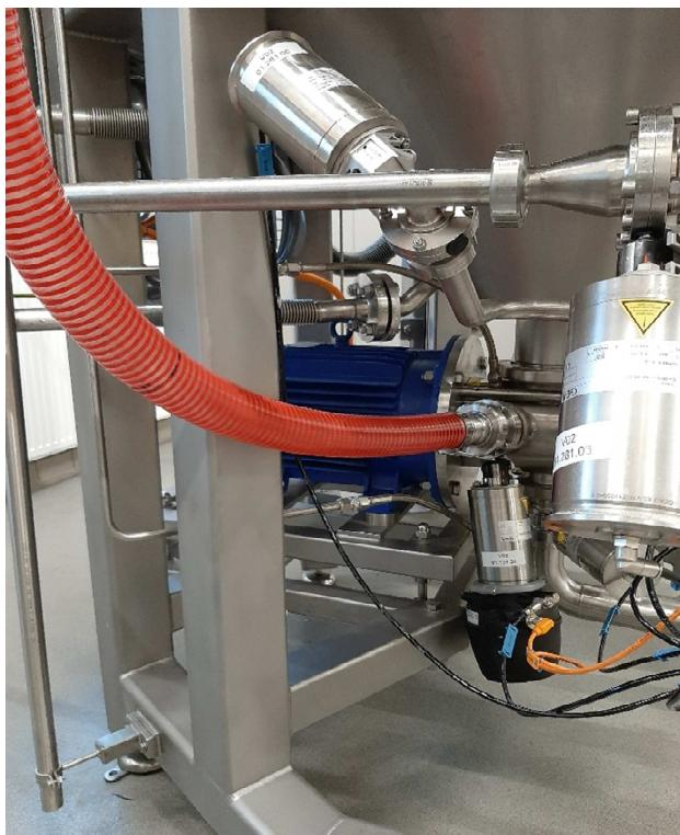
**Slika 7.** Vakuumska vod za uvlačenje tekuće faze u postrojenje (Izvor: D. Novosel).
