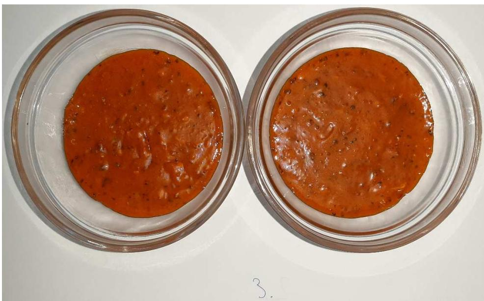
**Slika 47.** Prikaz kontrole vakuma za uzorak broj 3. lijevo originalni uzorak, desno uzorak dodatno vakumiran na 0,5 bar pri temperaturi 24°C.
