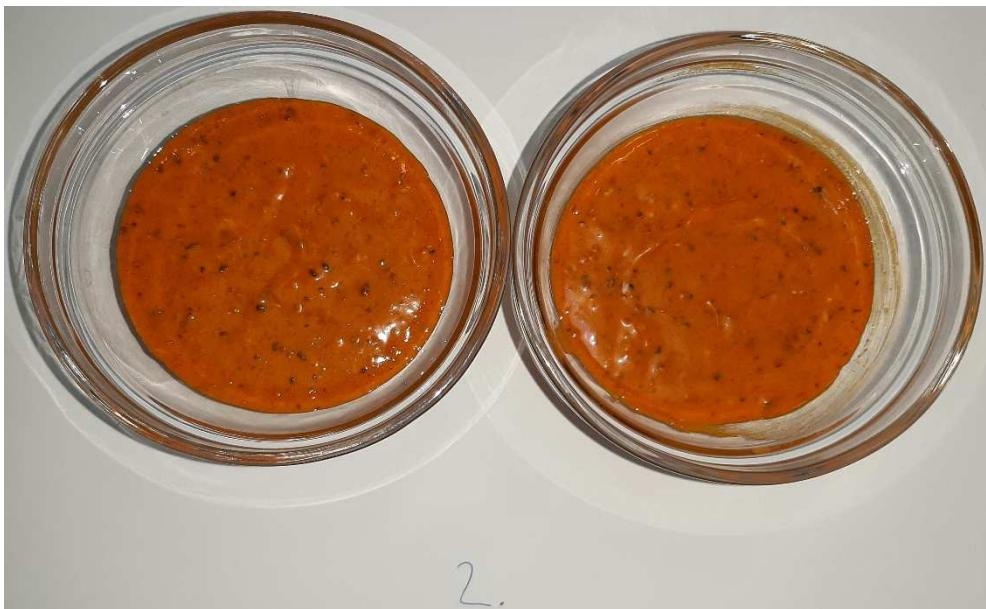
**Slika 46.** Prikaz kontrole vakuma za uzorak broj 2. lijevo originalni uzorak, desno uzorak dodatno vakumiran na 0,8 bar pri temperaturi 24°C.
