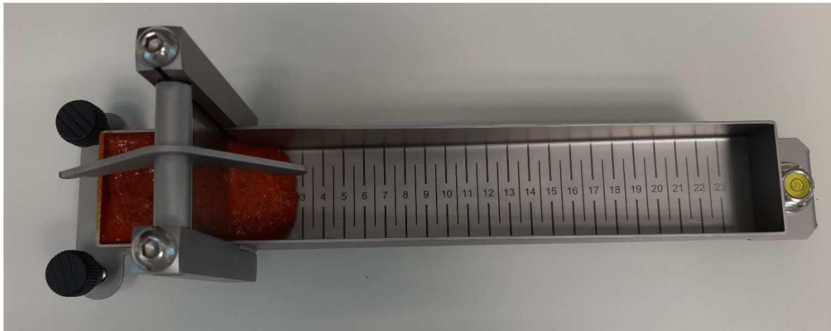
**Slika 35.** Bostwick konzistometar sa uzorkom (Izvor: D. Novosel).
