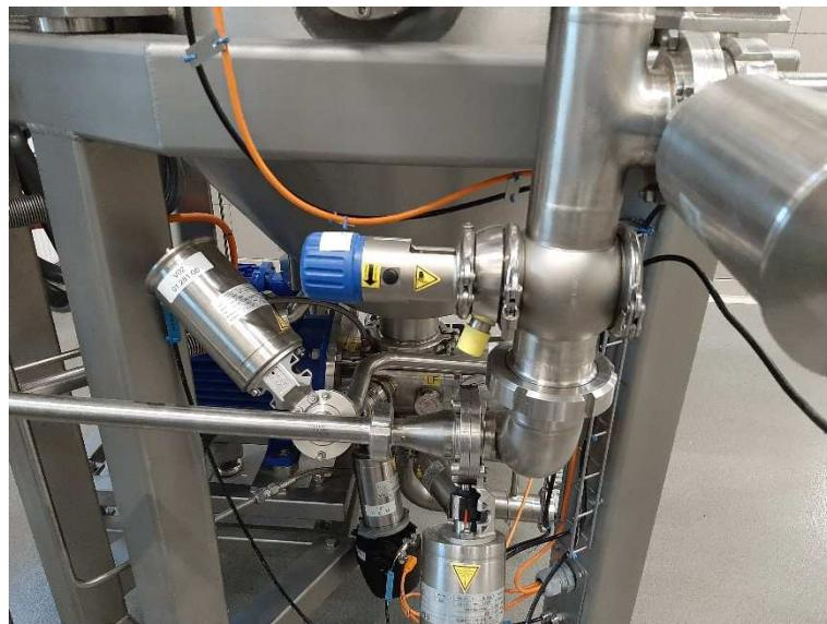
**Slika 14.** Ventil za uzimanje uzorka (Izvor: D. Novosel).
