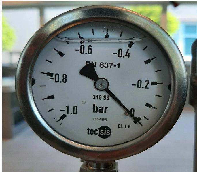
**Slika 29.** Manometar za praćenje vakuma (Izvor: D. Novosel)
