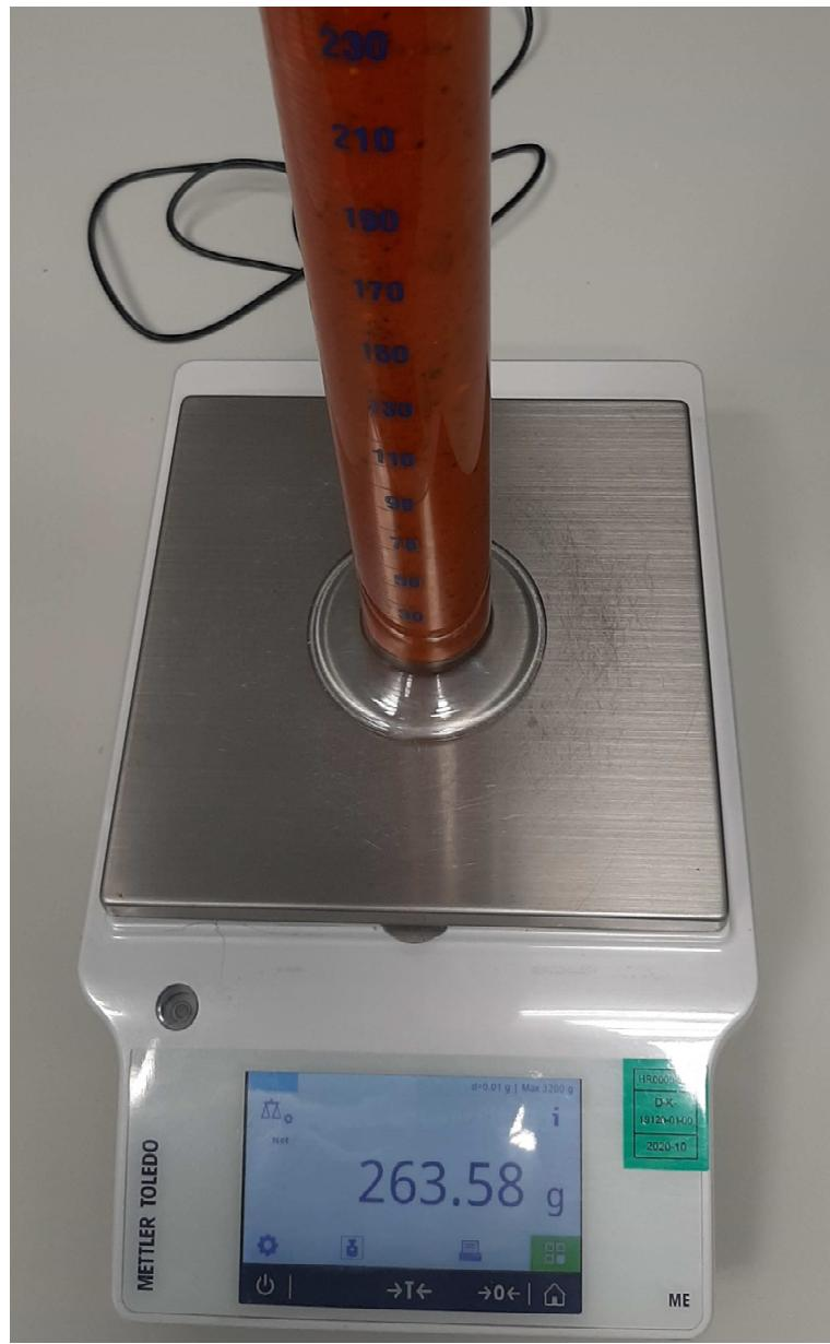
**Slika 34.** Digitalna vaga tvrtke Mettler Toledo sa preciznošću na 0,00 g, sa uzorkom.
