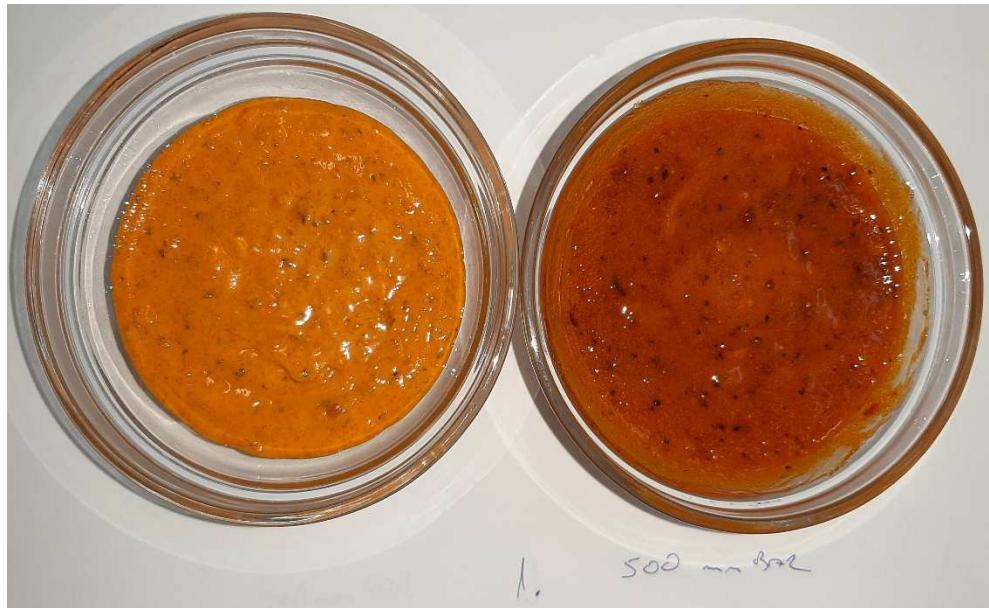
**Slika 50.** Prikaz kontrole vakuma za uzorak broj 1. lijevo originalni uzorak broj 1, desno uzorak broj 1. dodatno vakumiran na 0,5 bara pri temperaturi 24°C.
