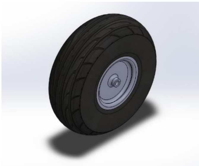
Slika 21. Pneumatski kotač nosivosti 136 kg (Solidworks 2017) \Phi 250 , debljine 80 mm
