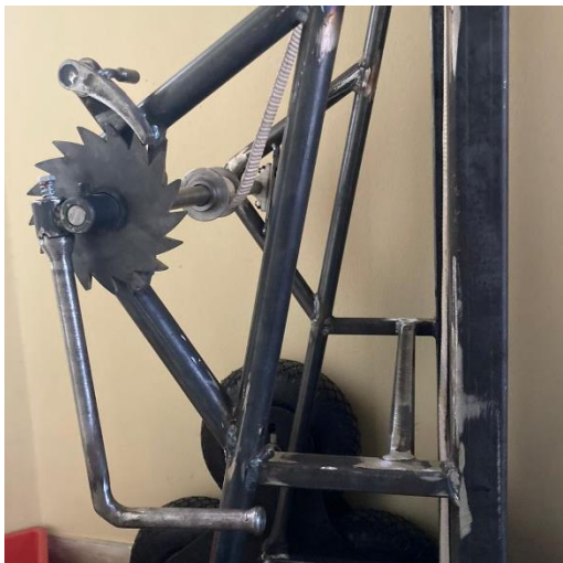
Slika 31. Izvedba sklopive ručke - (vožnja)
