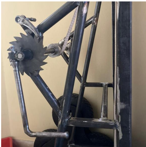
Slika 31. Izvedba sklopive ručke - (vožnja)
