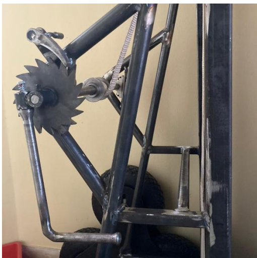
Slika 31. Izvedba sklopive ručke - (vožnja)
