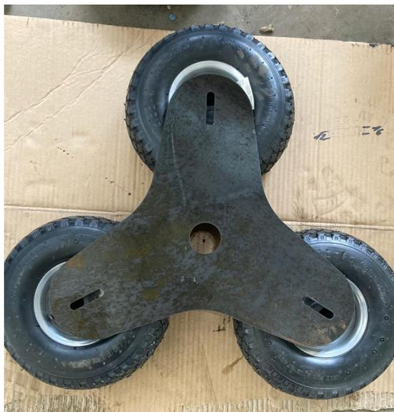
Slika 23. Postupak spajanja kotača i zvijezda
