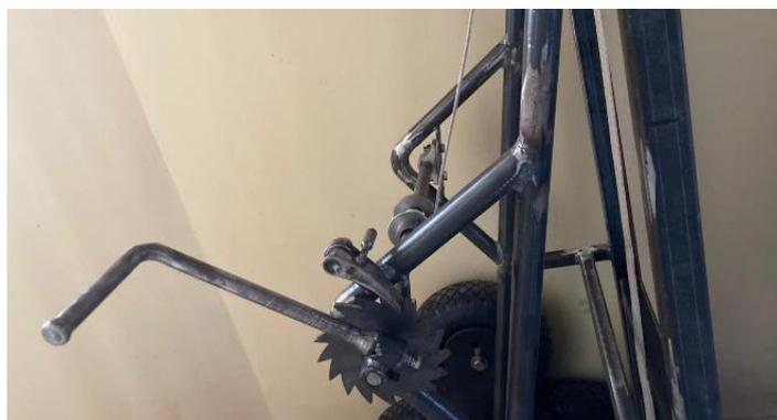
Slika 30. Izvedba sklopive ručke - radni položaj (namatanje)
