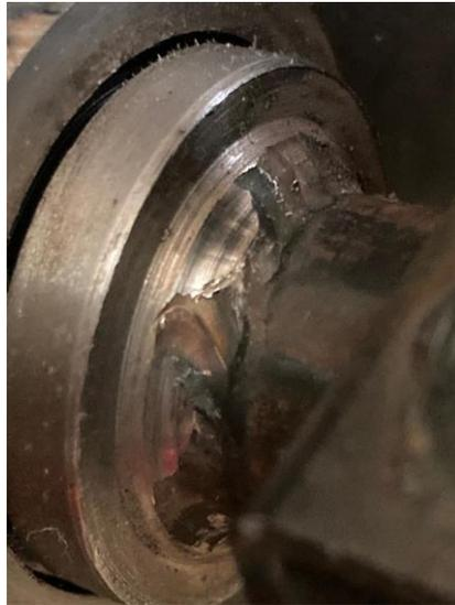
Slika 12. Kutni kružni zavareni spoj između osovine i zvijezde kotača
