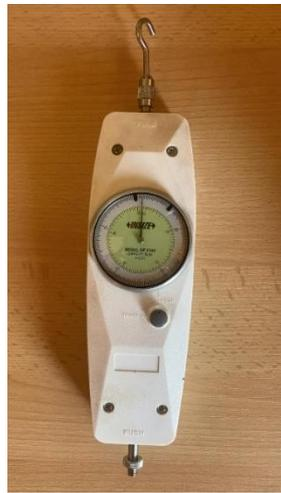
Slika 33. Dinamometar za provođenje ispitivanja (max. 500 N  $\pm$  1%)
