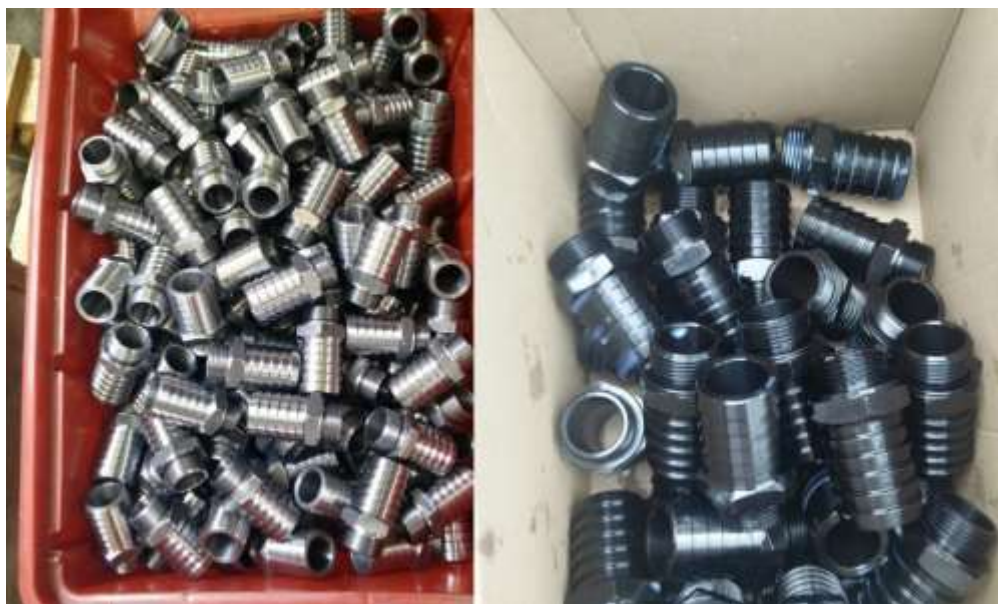
Slika 16. Prikaz strojnih dijelova prije i poslije bruniranja [4].
