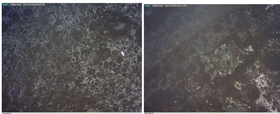
Slika 35. Površina poliranog čelika (lijevo) i bruniranog (desno) s premazom 1 snimljene optičkim metalografskim mikroskopom nakon izlaganja djelovanju otopine HCl.
