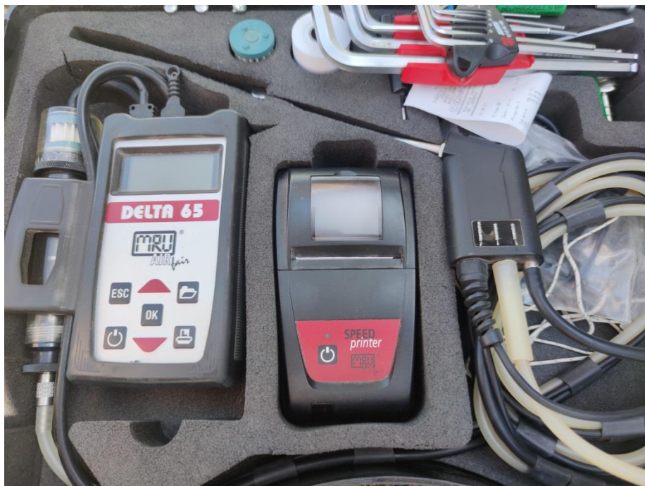
Prilog 7: Aparat za mjerenje izlaznih plinova
