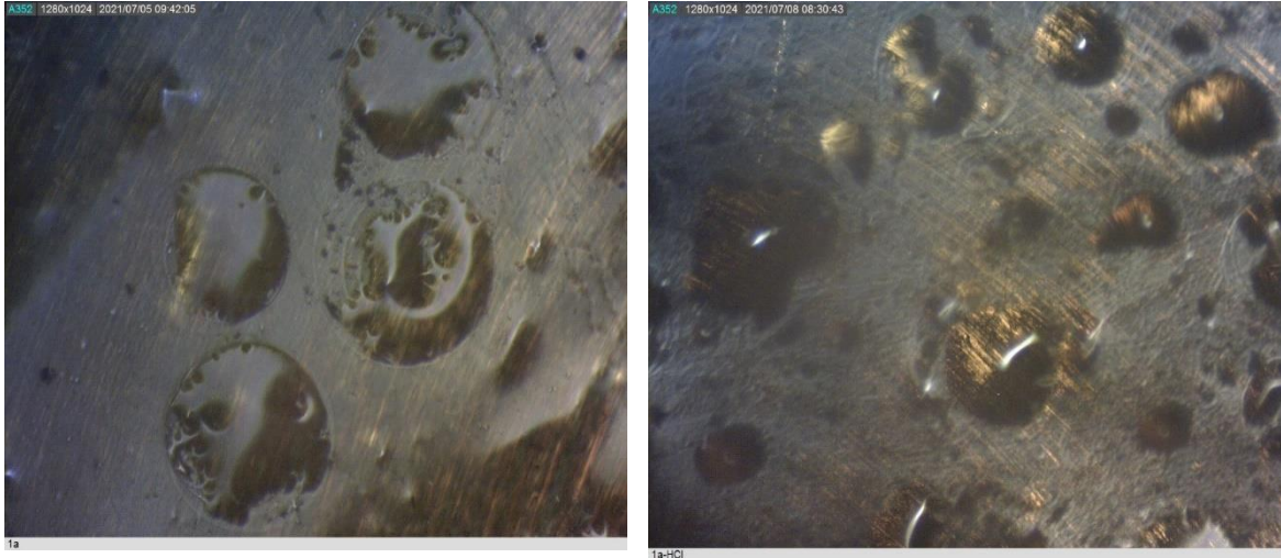
Slika 37: Površine poliranog čelika s Premazom 1 snimljene optičkim metalografskim mikroskopom prije i nakon izlaganja djelovanju 5% otopine HCl u trajanju od 2 h na 25 °C
