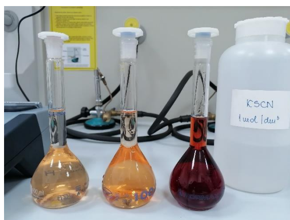
Slika 27: Pripremljene otopine za određivanje sadržaja željeza spektrofotometrijski
