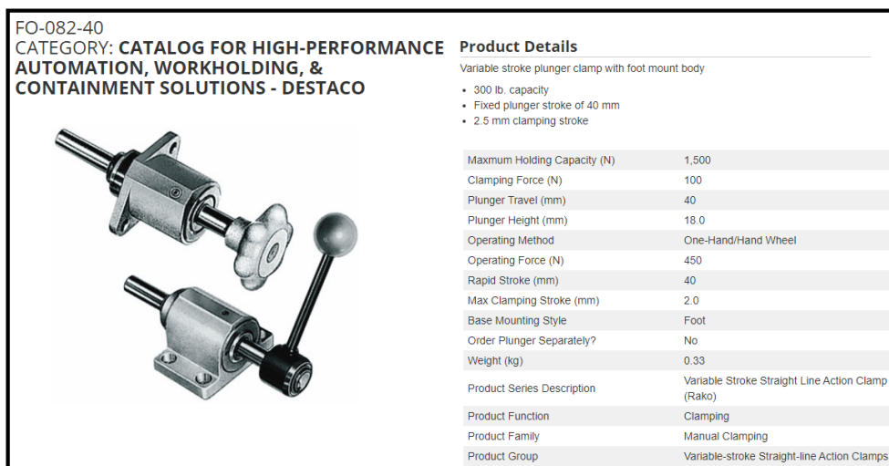
Slika 25. DESTACO stezač FO-082-40 [12.]
