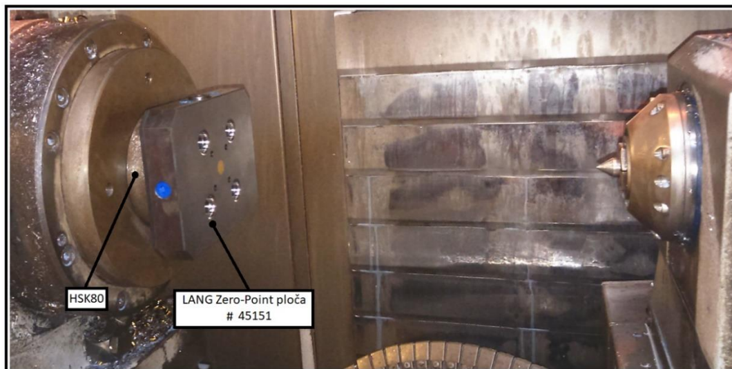
Slika 58. Sklop HSK80+LANG Zero-Point ploče br. 45151
