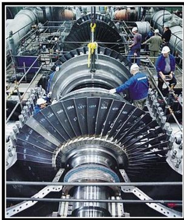
Slika 1. Parna turbina s otvorenim kućištem [1.]
