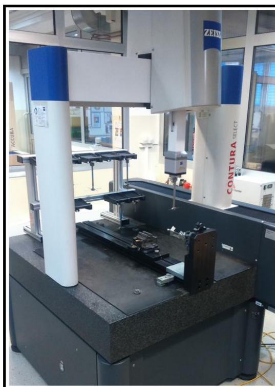
Slika 124. Naprava za mjerenje na CMM uređaju – lopatica u procesu mjerenja - 2
