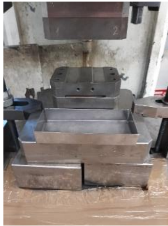
Slika 54 Predodžba alata za ravnjanje platine povlakača
