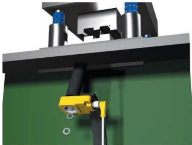
Slika 47 Predodžba senzora za detekciju izbačenih komada. Izvor [14]
