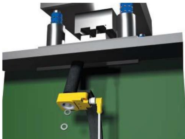
Slika 47 Predodžba senzora za detekciju izbačenih komada. Izvor [14]
