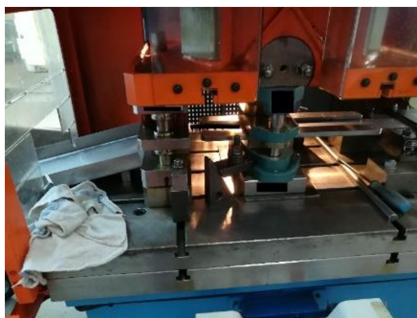
Slika 53 Predodžba automatizirane izrade platine povlakača na starom alatu
